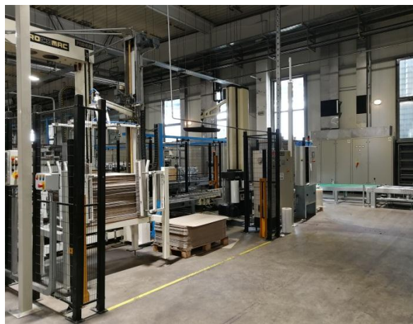
Slika 15. Paletizator i prostor za omotavanje paleta
