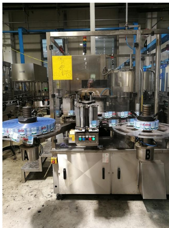
Slika 7. Etiketirka – prikaz spojenog koluta
