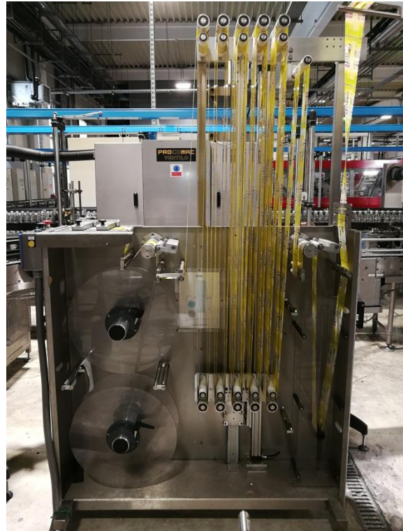
Slika 9. „Sleeve“ etiketirka – prikaz spojenog koluta
