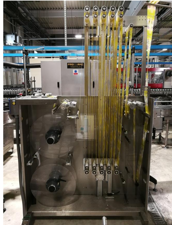
Slika 9. „Sleeve“ etiketirka – prikaz spojenog koluta
