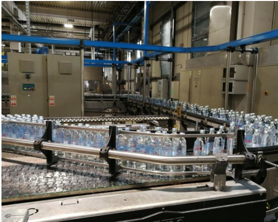
Slika 10. Transportna traka od etiketirke do upakivača
