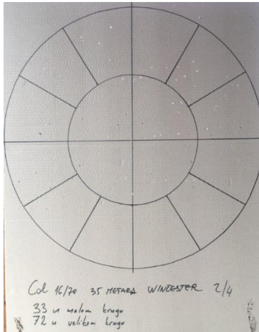
Slika 16: Meta pogođena na 35 metara metkom Winchester kalibra 16/70
