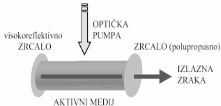
Slika 9. Dijelovi lasera
