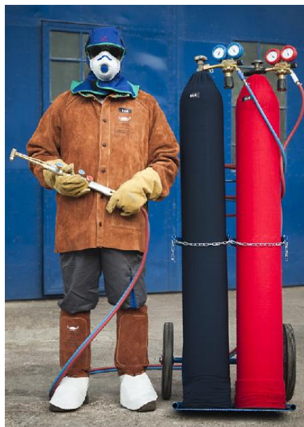
Slika 29. Oprema za plinsko zavarivanje
