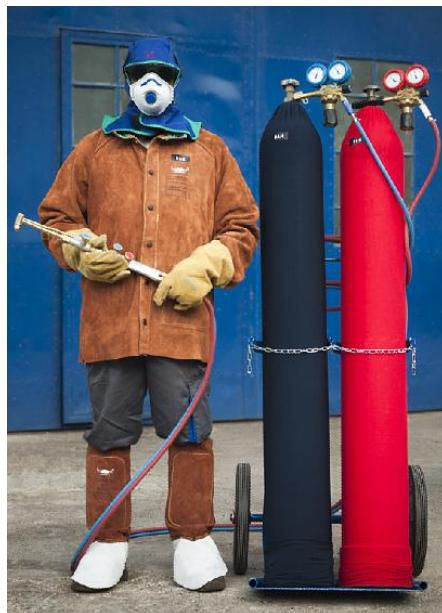
Slika 29. Oprema za plinsko zavarivanje
