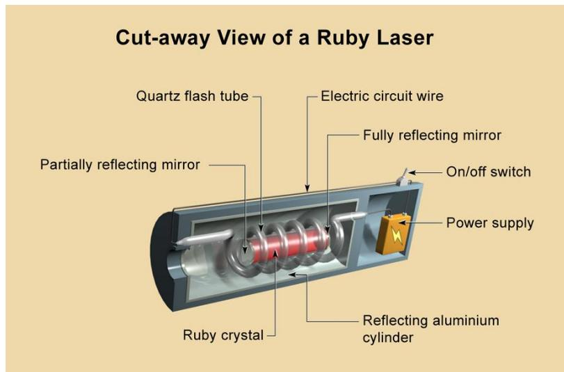
Slika 1. Dijelovi prvog (rubinskog) lasera
