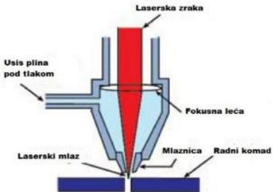
Slika 15. Laser za rezanje metala
