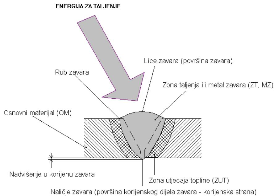
Slika 16. Zavarivanje taljenjem
