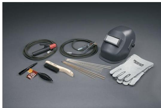
Slika 28. Oprema za zavarivanje
