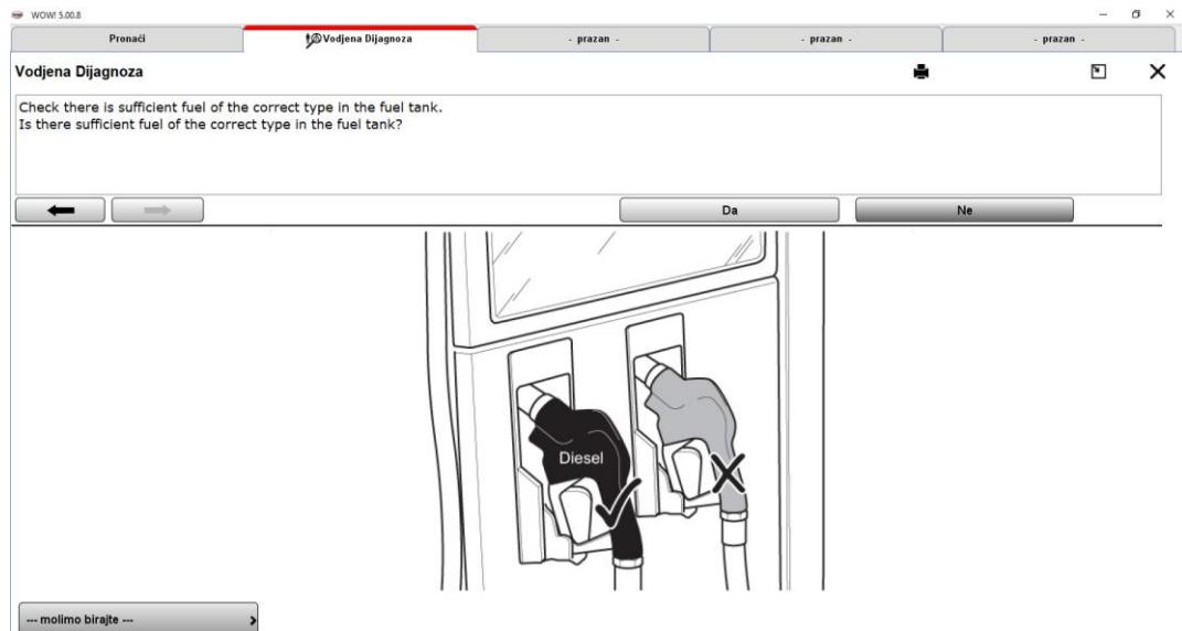
**Slika 28. Upit vođene dijagnostike ispravnosti goriva u vozilu**
