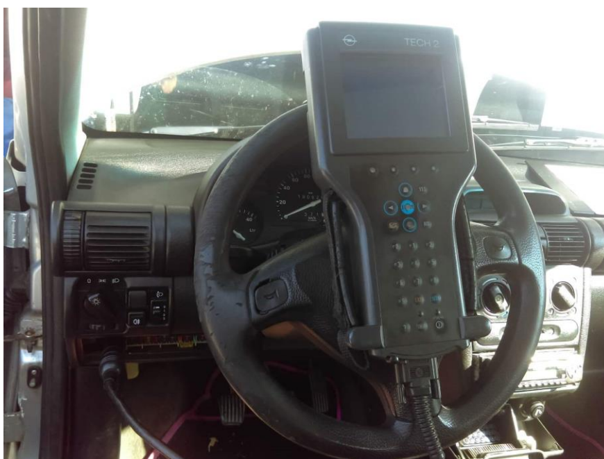
Slika 34. Spajanje GM Tech-2 dijagnostike na vozilo
