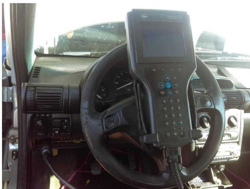
Slika 34. Spajanje GM Tech-2 dijagnostike na vozilo
