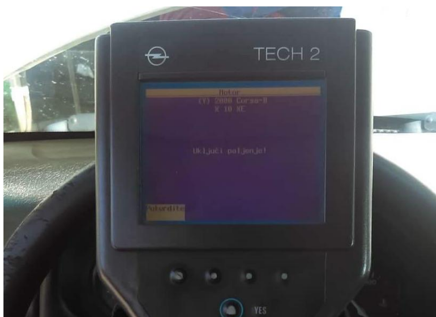
Slika 36. Uputa dijagnostike za paljenje kontakta na vozilu
