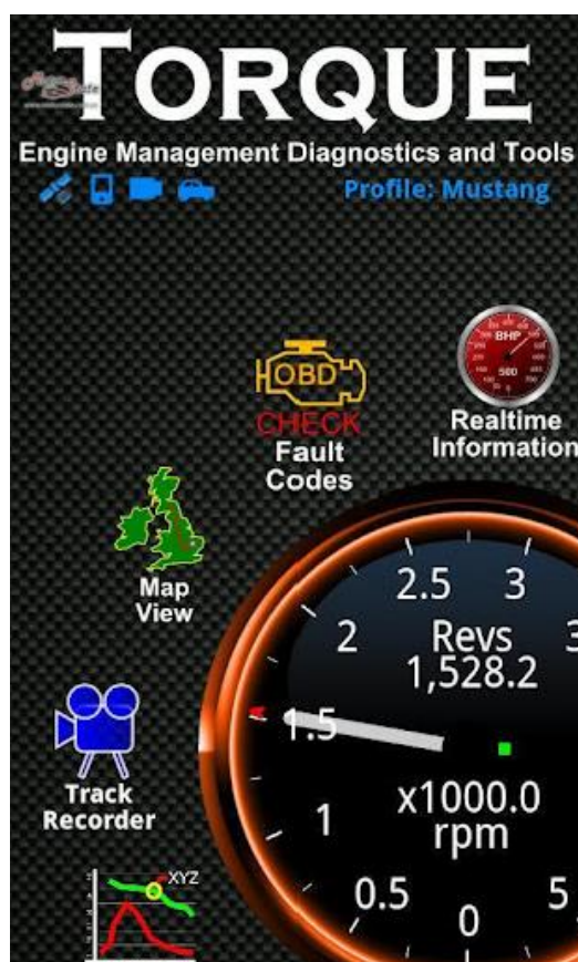
Slika 16. „Torque“ Android aplikacija za ELM327 dijagnostiku
