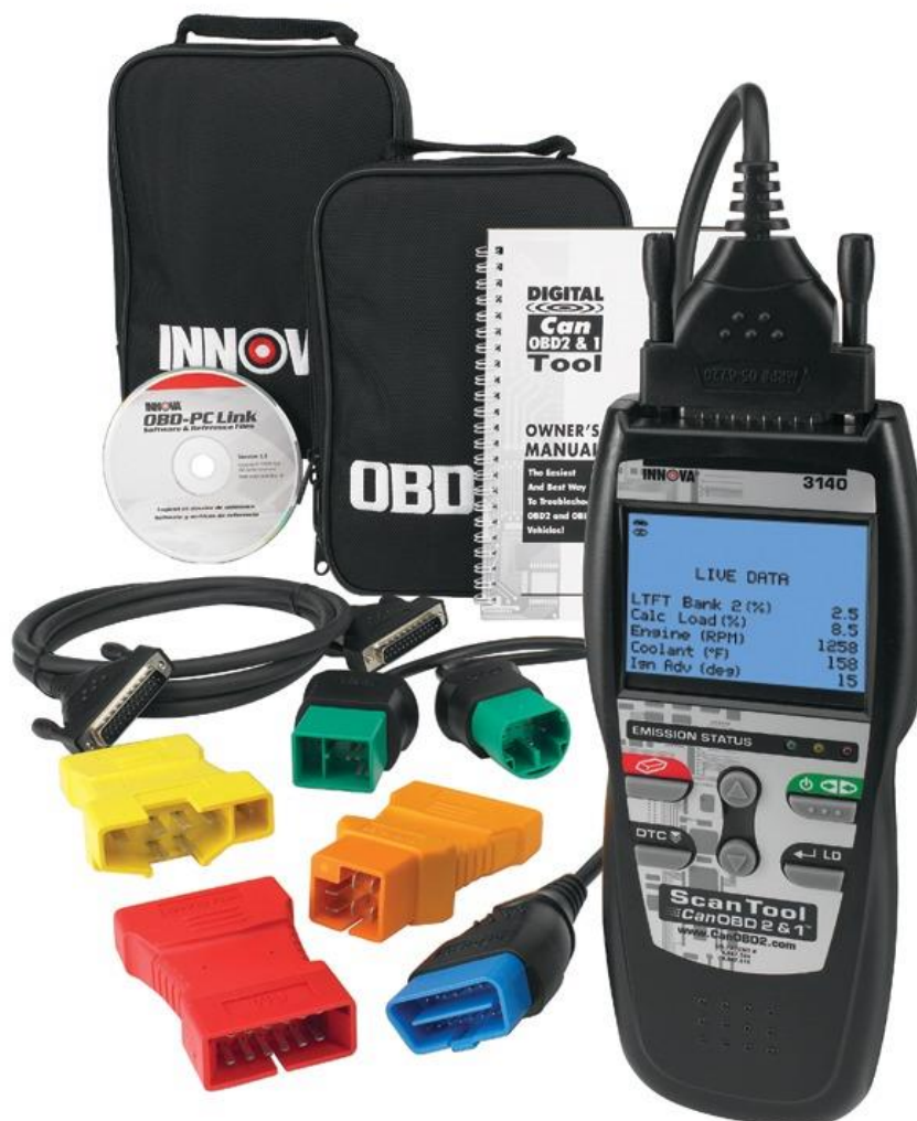
Slika 5. OBD dijagnostički set sa priključcima raznih proizvođača
