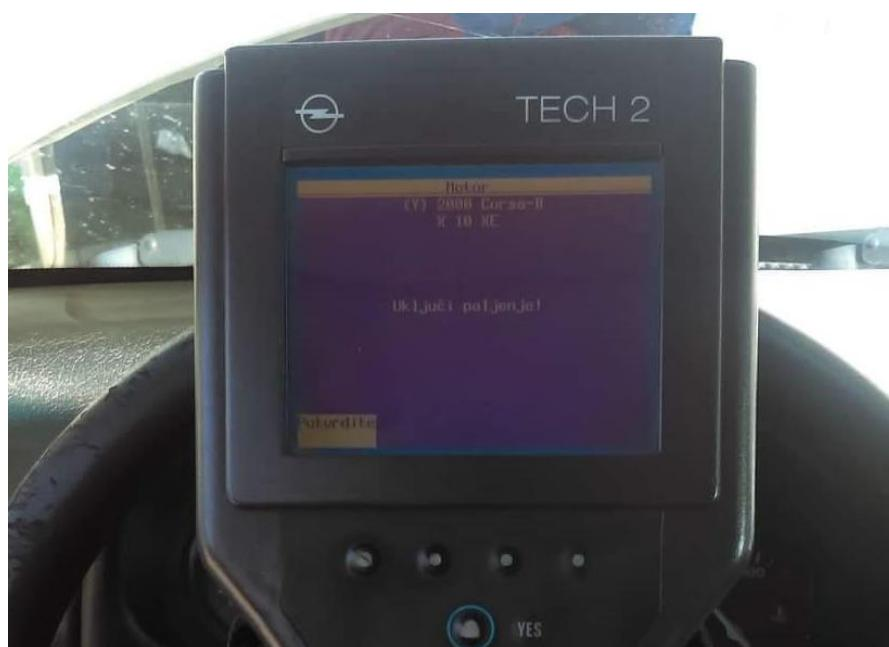
**Slika 36. Uputa dijagnostike za paljenje kontakta na vozilu**
