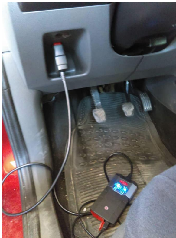
Slika 19. Primjer uspješnog spajanja dijagnostike
