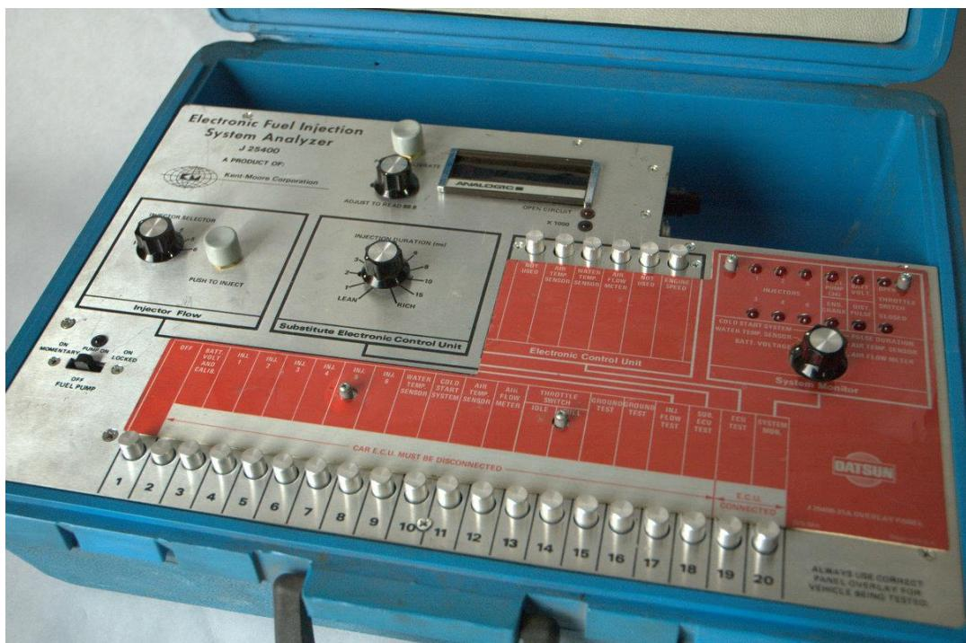
**Slika 4. Primjer prvih električnih dijagnostičkih uređaja**
