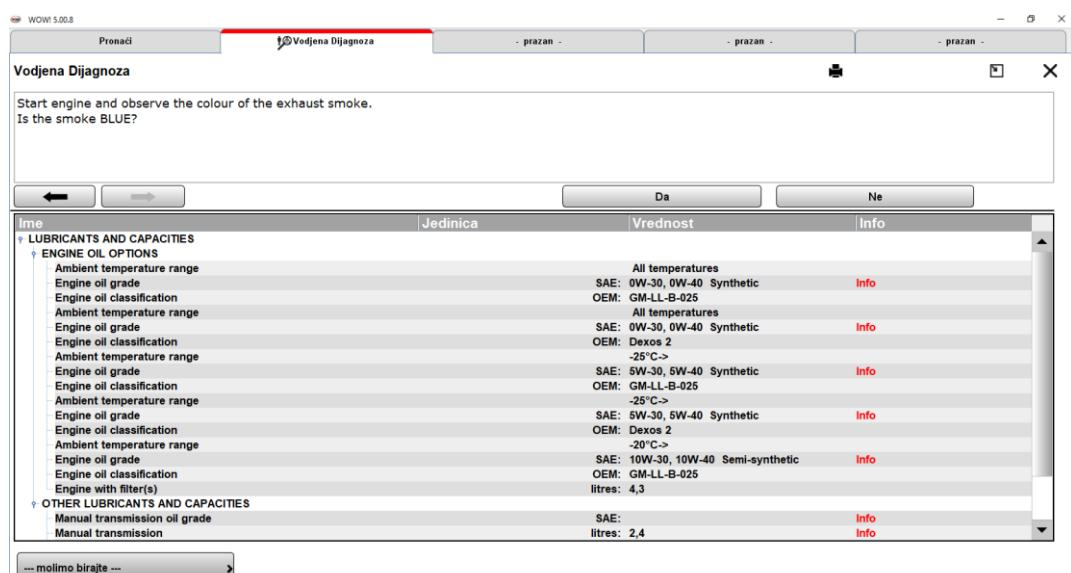
**Slika 29. Upit vođene dijagnostike o boji ispušnog dima**
