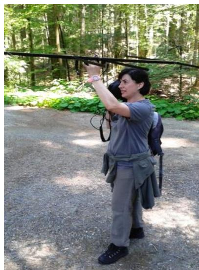
Slika 9: Hvatanje signala antenom i radio-prijemnikom
