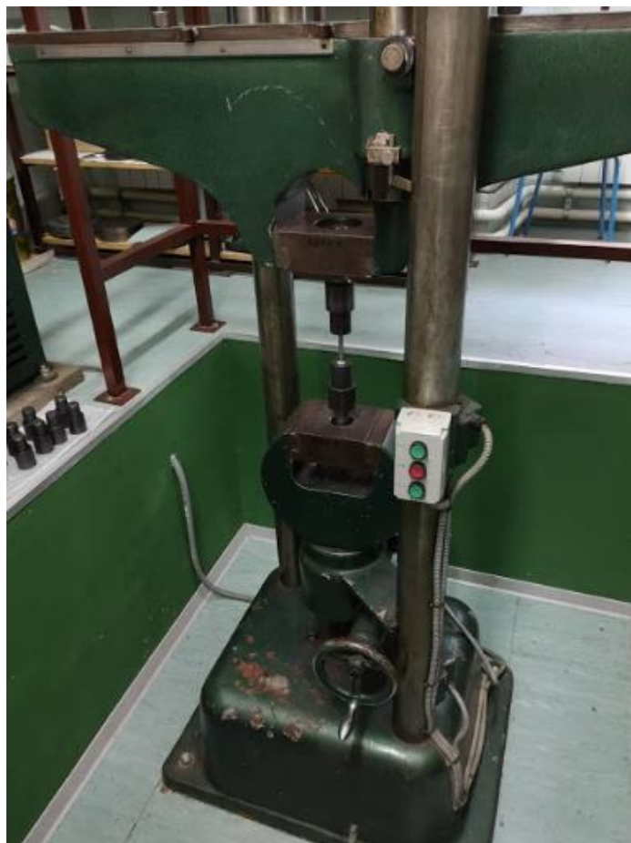
Slika 30: Kidalica proizvođača Otto Wolpert Werke
