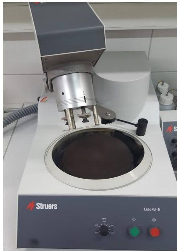
Slika 35: Uređaj za poliranje Struers, modela LoboPol-5
