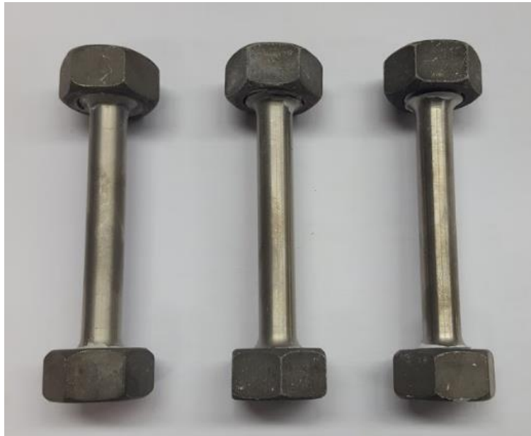
Slika 27: Priprema epruveta za proces nitriranja
