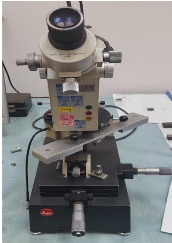
Slika 37: Mikrotvdomjer Leitz Wetzlar model Durimet 2
