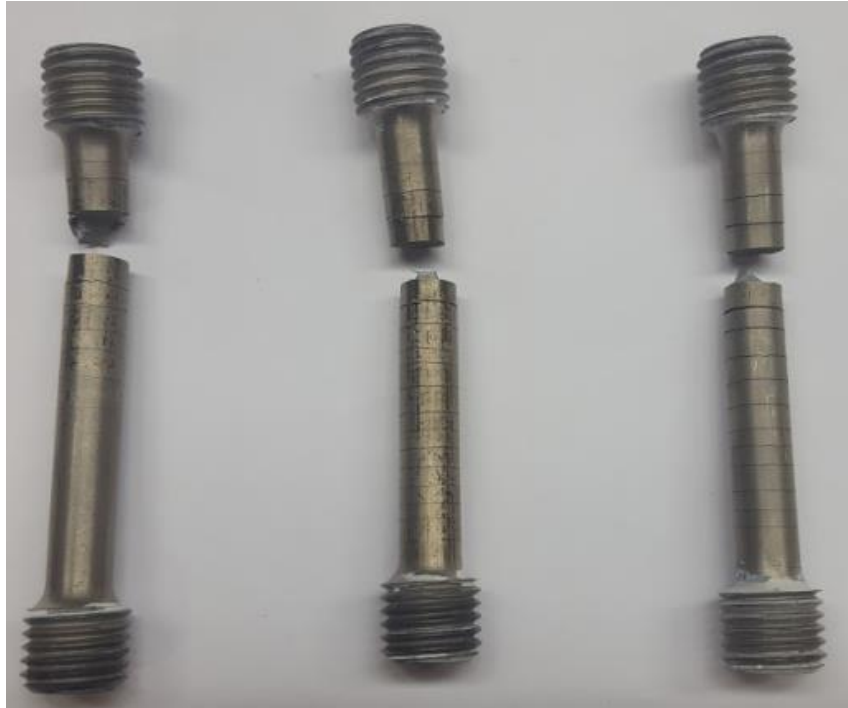
Slika 31: Epruvete nakon vlačnog ispitivanja
