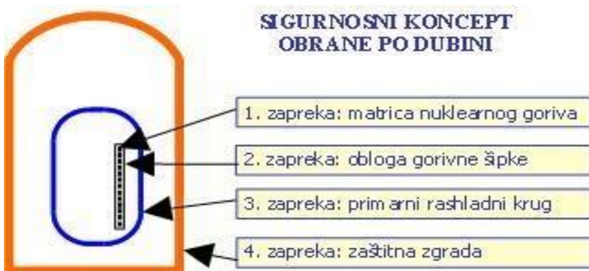
Slika 6. Obrambeni sustav nuklearne elektrane od radioaktivnog zračenja
