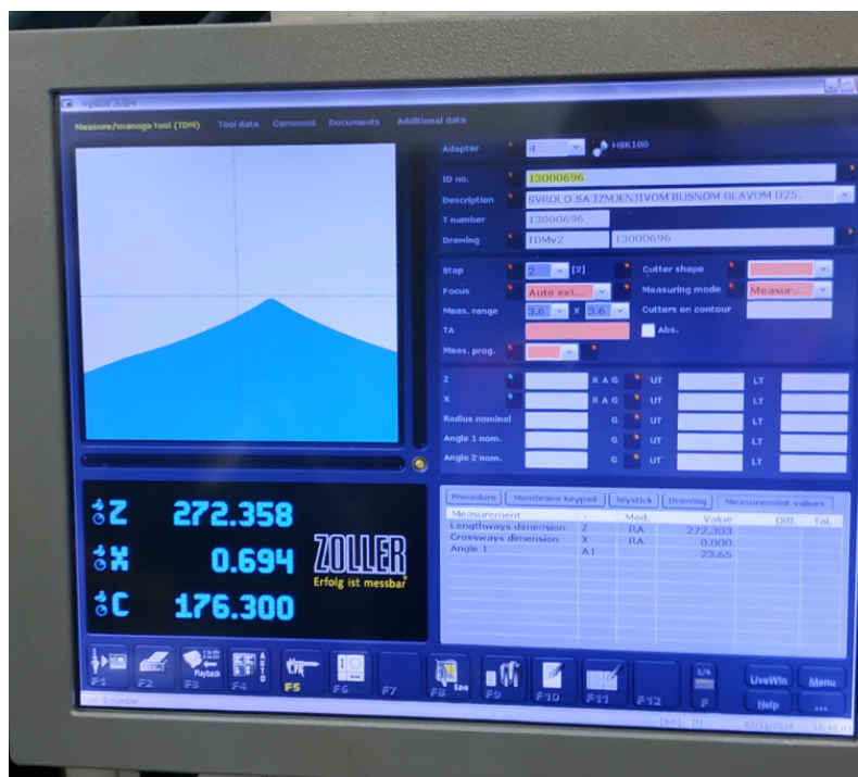
Slika 4.14 Mjerenje dužine alata na vrhu svrdla
