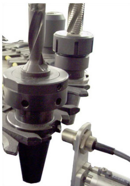
Slika 4.10 RFID čitač na stanici za punjenje alata
