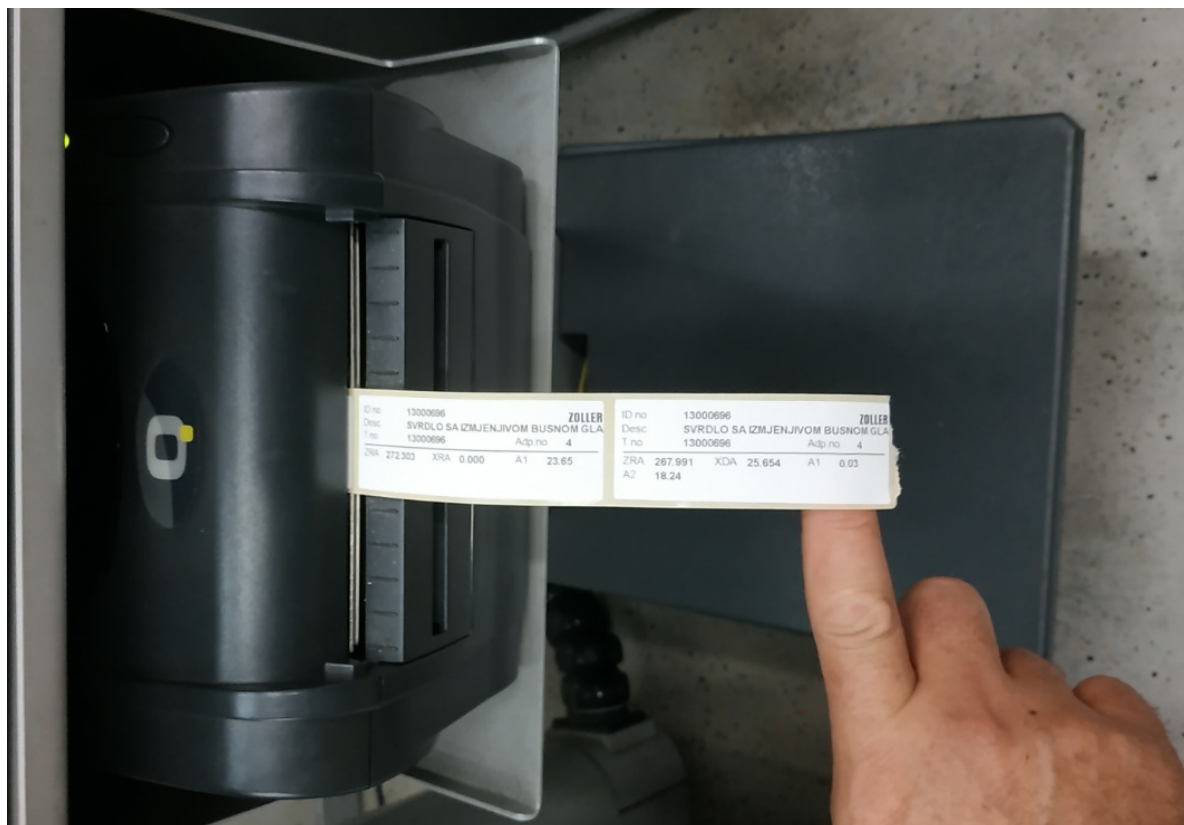
Slika 4.15 Etikete s izmjerama dužine i promjera alata
