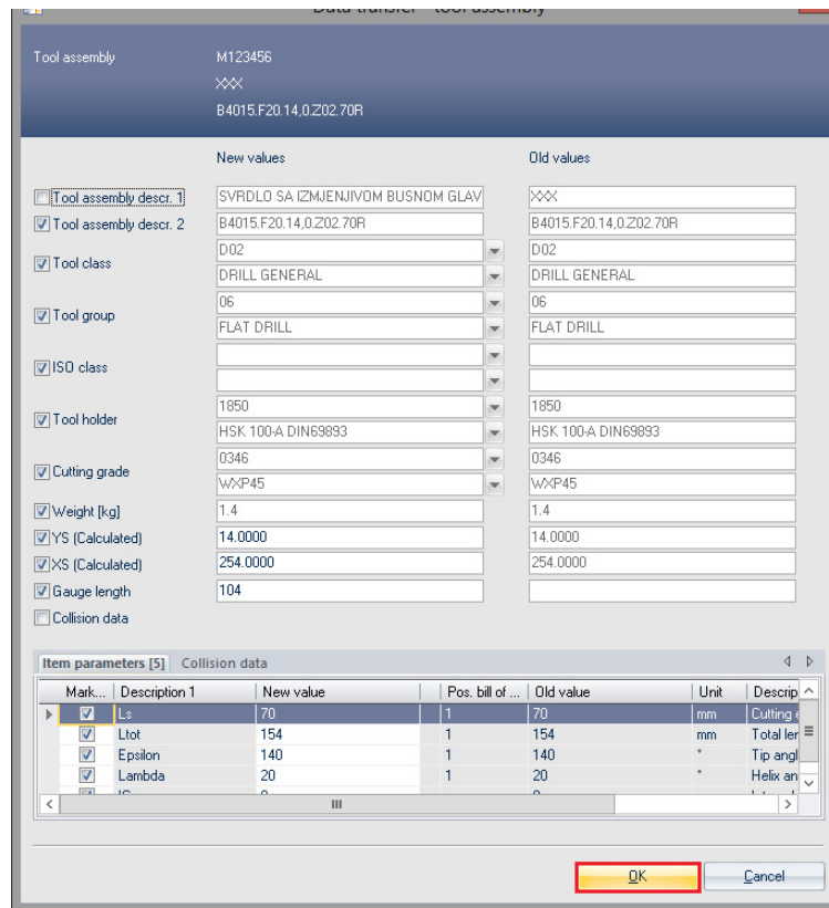
Slika 2.20 Završno kreirani sklop alata s „Data transfer“ prozorom
