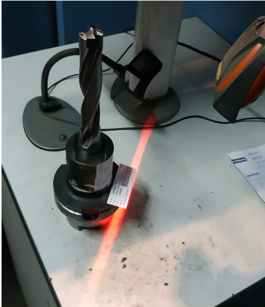
Slika 4.19 Očitavanje jedinstvenog brojevnog naziva pomoću bar-kod čitača
