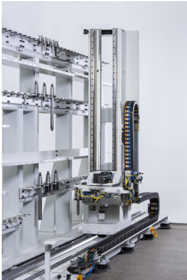
Slika 4.8 Regalno spremište alata s manipulatorom
