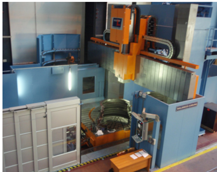
Slika 1.2 Obradni centar Waldrich Coburg Master Tec 4500 AT
