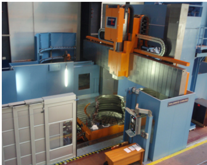
Slika 1.2 Obradni centar Waldrich Coburg Master Tec 4500 AT
