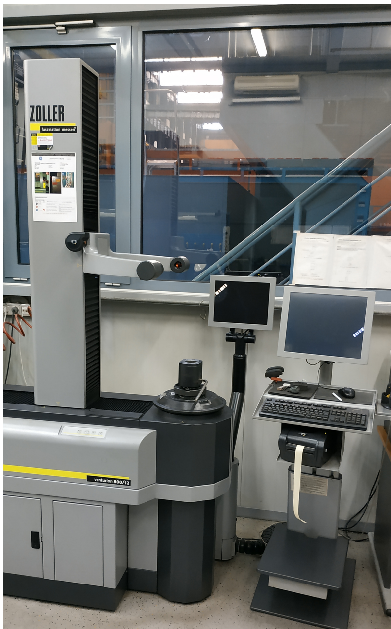
Slika 4.4 Zoller venturion 800/12 uređaj za prednamještanje alata
