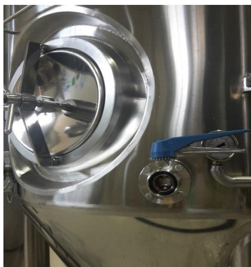
Slika 12. Ventil za uzimanje uzorka, pigtail
