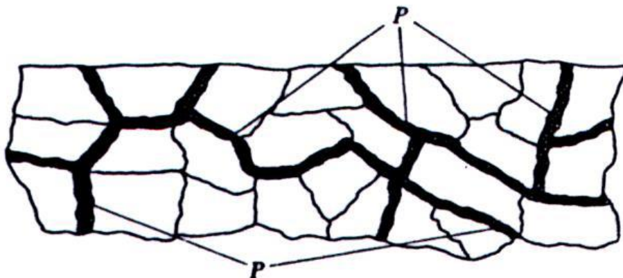
Slika 6. Interkristalna korozija (Esih i Dugi, 1997).
