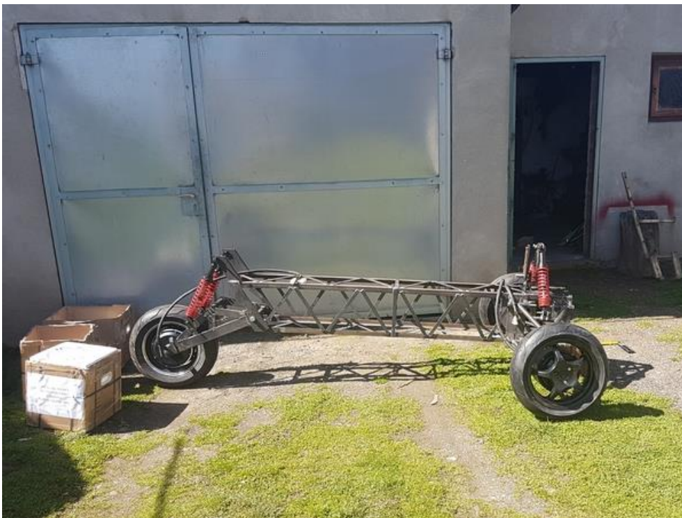
Slika 85.: Prikaz prednjeg i zadnjeg ovjesa montiranih na konstrukciju s motorima i gumama
