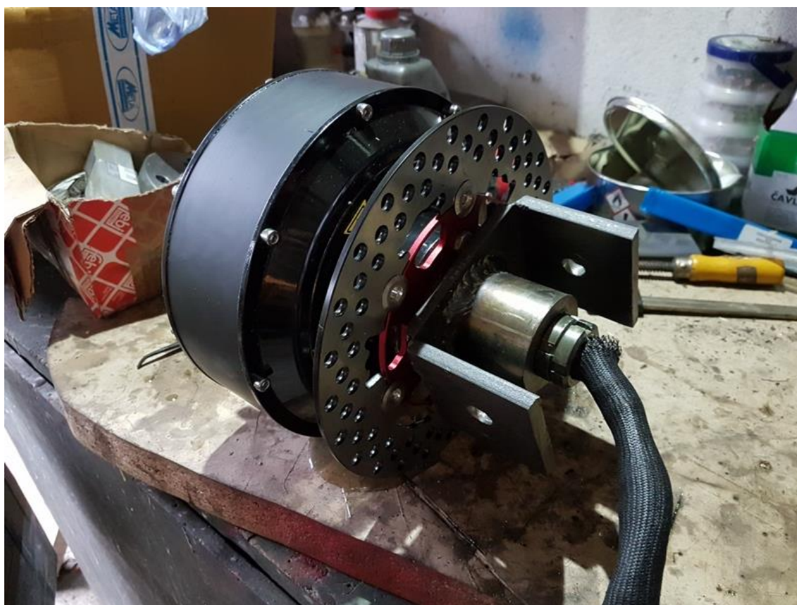
Slika 81.: Montaža prednjeg motora na C-nosač
