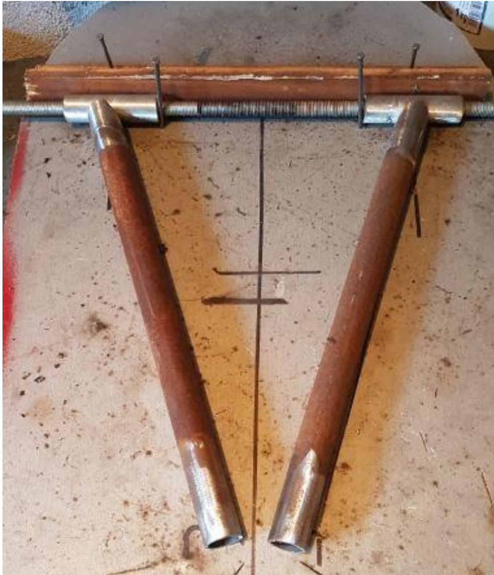
Slika 71.: Priprema za zavarivanje prednje vilice
