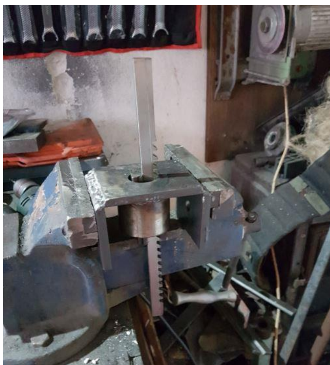
Slika 76.: Provlačenje provlačila za izradu utora za klin
