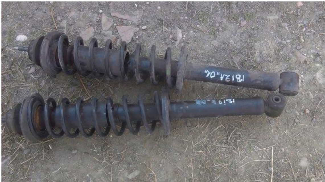
Slika 35.: Amortizeri za prednje kotače (Seat Ibiza, 2001.)
