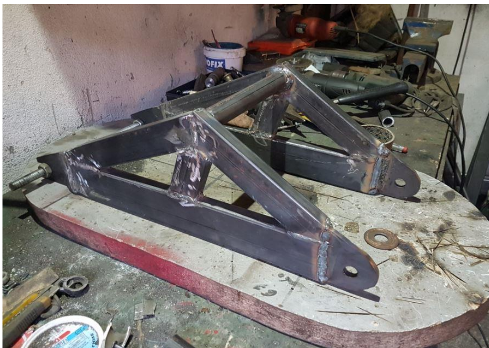
Slika 74.: Zadnja vilica, priprema za daljnju obradu
