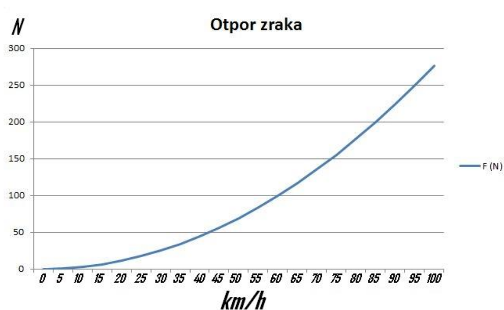
Dijagram 5.: otpor zraka u zavisnosti od brzine
