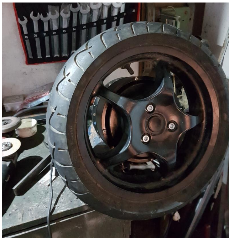
Slika 82.: Montaža gume i felge na flandū motora
