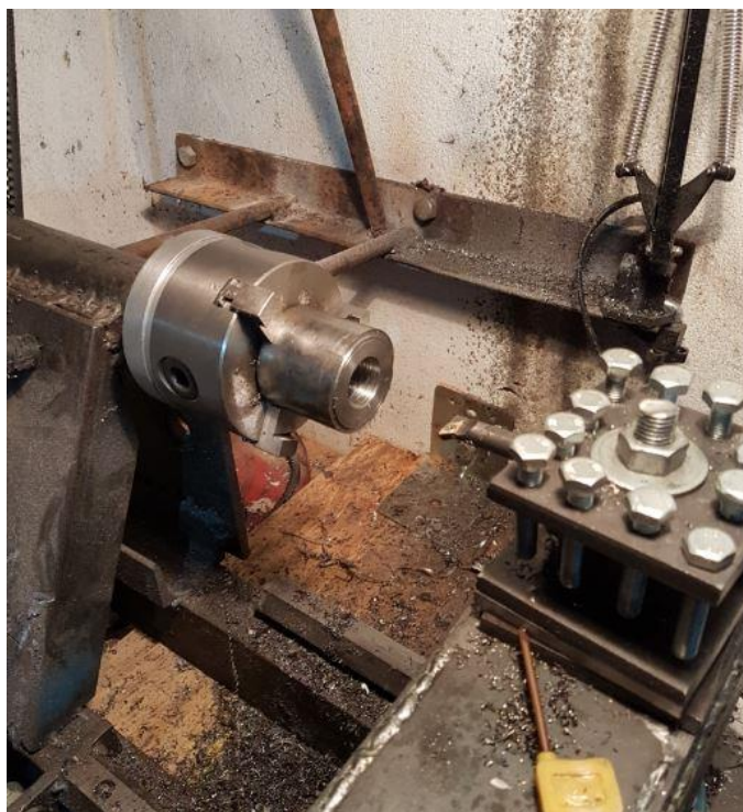
Slika 75.: Tokarenje provrta osovine za elektromotor
