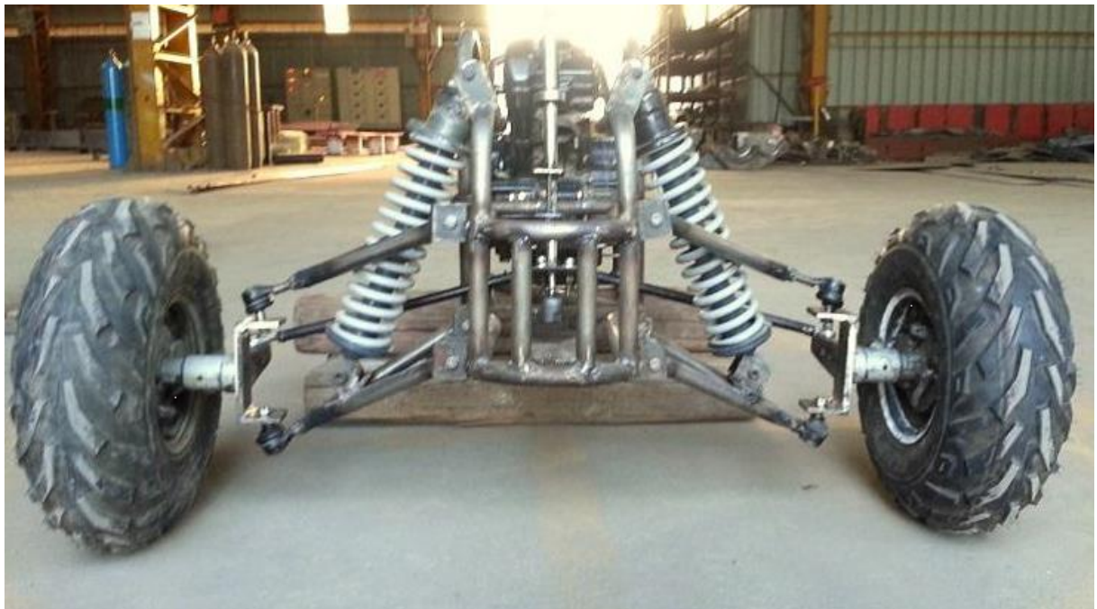
Slika 40.: Primjer ovjesa kod ATV vozila
