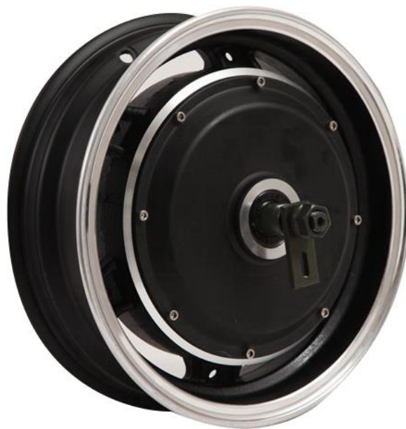
Slika 23.: QS Motor 12*3.5inch 205 3000W 50H V3 sa strane (desno)
