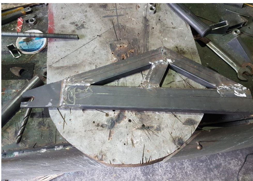
Slika 73.: Zavareni dio zadnje vilice
