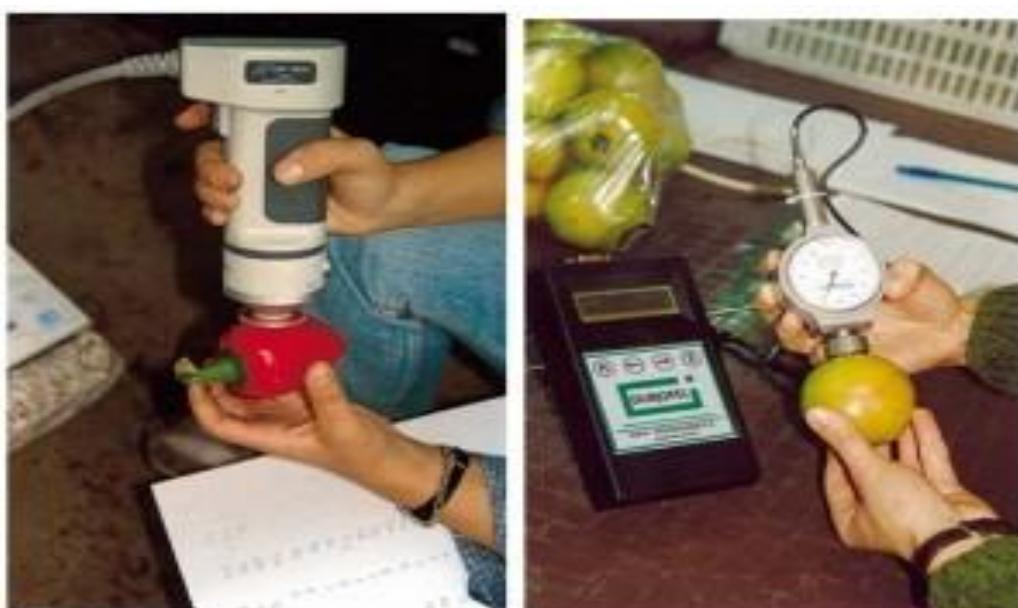
**Slika 6.** – Aparati za mjerjenje zrelosti voća kolorimetrom i penetrometrom. Izvor; <https://www.tehnologijahrane.com/enciklopedija/branje-i-priprema-voca-i-povrca-zaskladistenje>, pristupljeno 01.02.2019.
