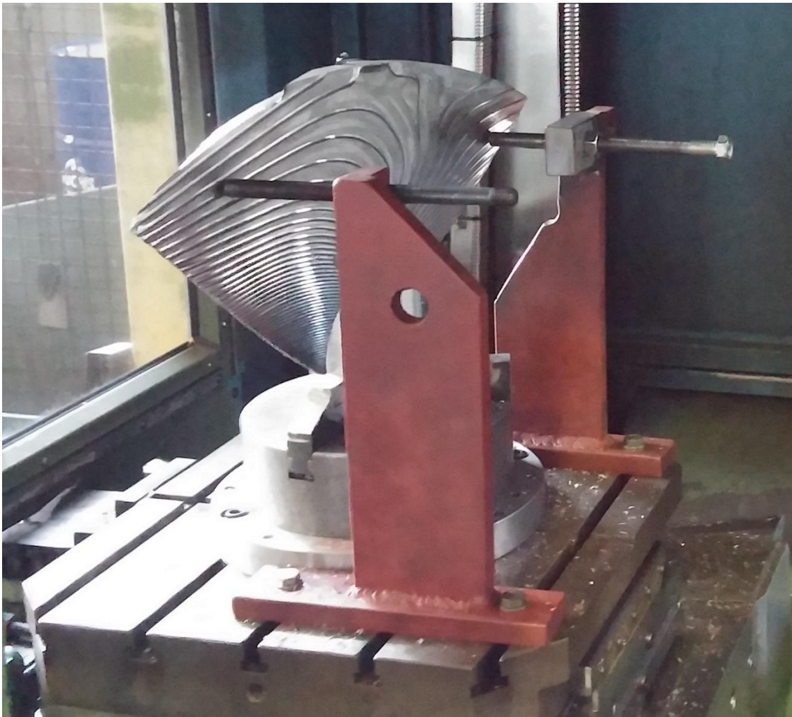
Slika 42. Stezanje sa zategama
