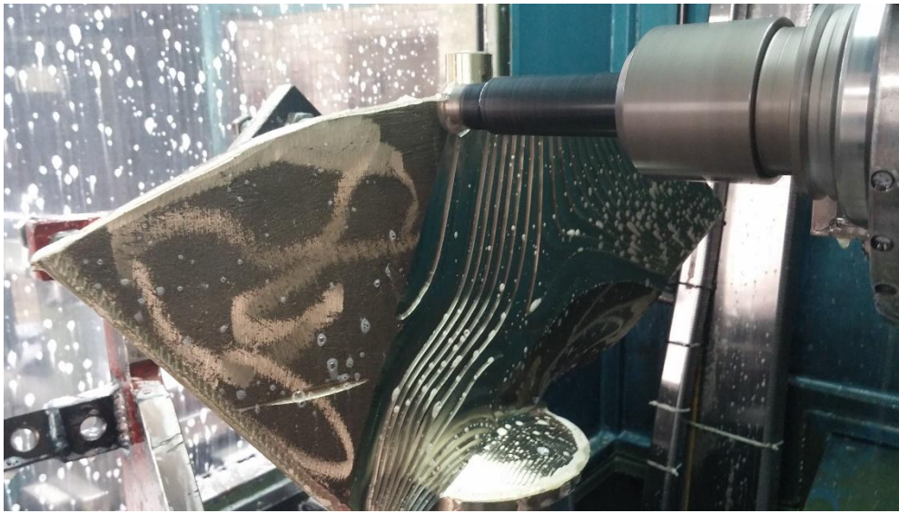
Slika 50. 2. stezanje, gruba obrada
