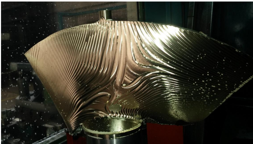
Slika 51. Površina nakon grube obrade
