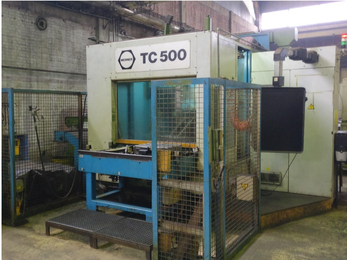
Slika 36. Werner TC500 obradni centar
