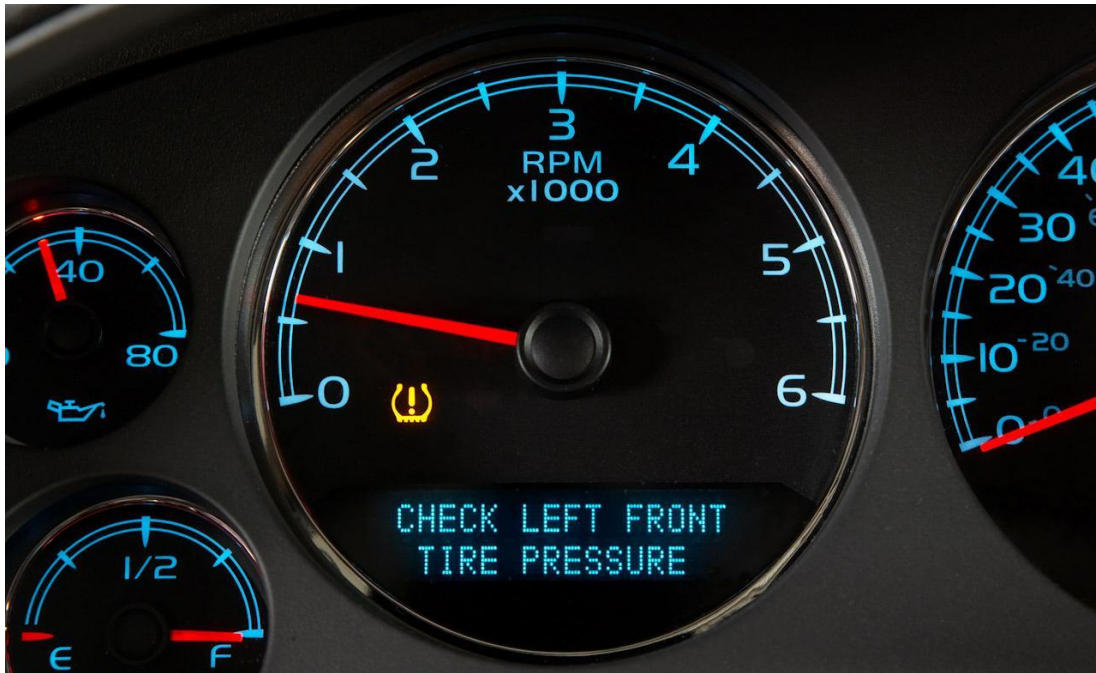
Slika 30. TPMS sustav na kontrolnoj ploči
