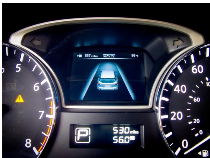
Slika 28. LDW sustav na kontrolnoj ploči
