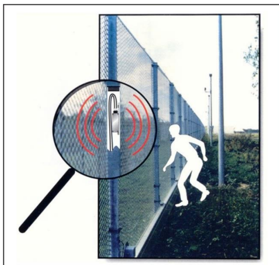
Slika 8. Detektori koji reagiraju na zvuk
