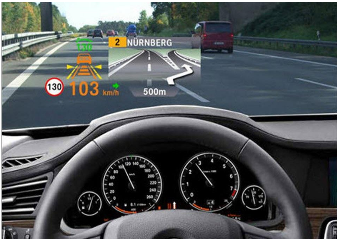
Slika 34. Prozirni ekran HUD sustava
