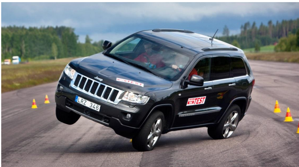
Slika 19. Prikaz djelovanja ESP sustava
