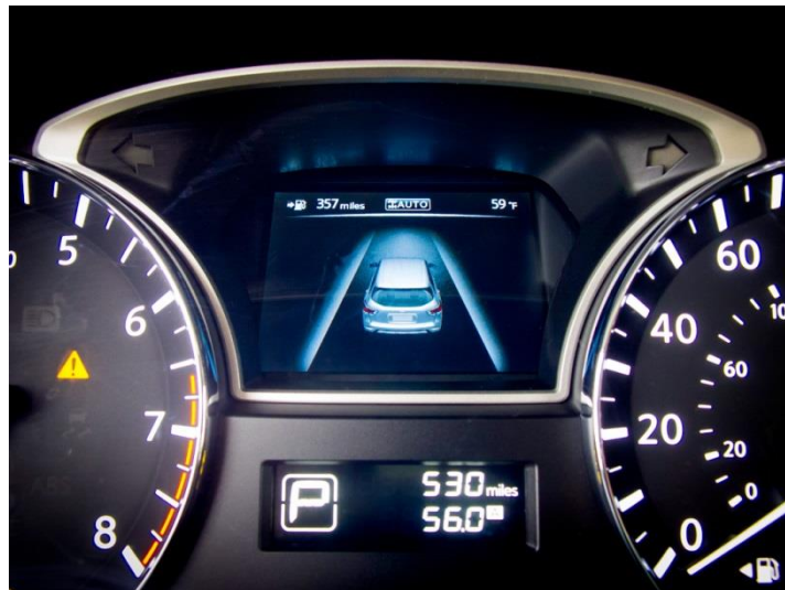
Slika 28. LDW sustav na kontrolnoj ploči
