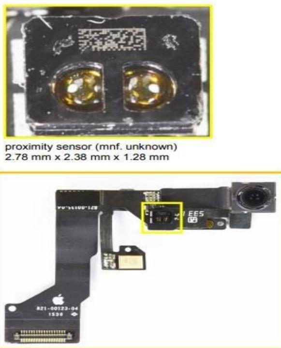
Slika 14. Predodžba senzora blizine
