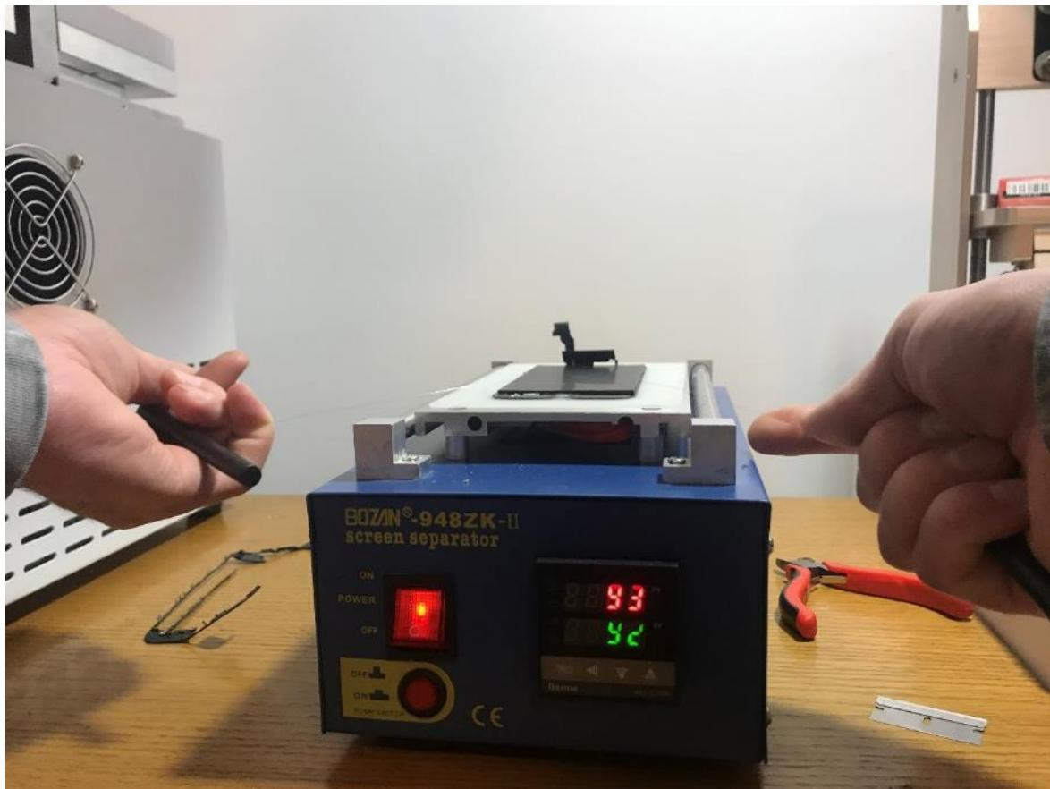
Slika 30. Predodžba odvajanja stakla od LCD-a. Izvorno autor.
