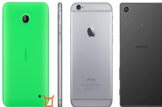
Slika 3. Predodžba polimernih, metalnih (aluminijska) i staklenih kućišta
