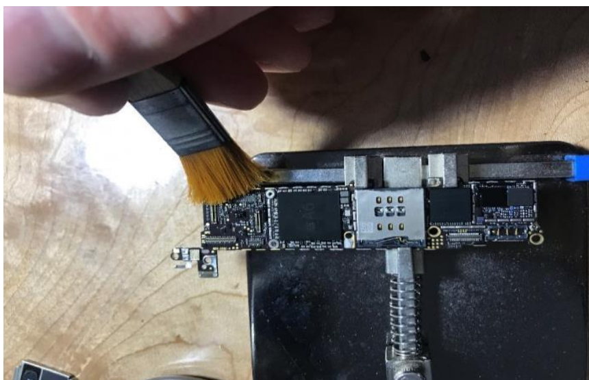
Slika 25. Predodžba čišćenja oksidacije. Izvorno autor.
