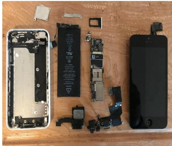
Slika 23. Predodžba dijelova Iphone 5c uređaja. Izvorno autor.
