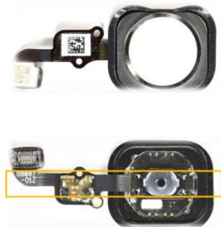
Slika 22. Predodžba senzora otiska prsta
