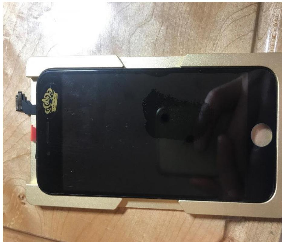
Slika 32. Predodžba LCD ekrana s novim stakлом u kalupu. Izvorno autor.
