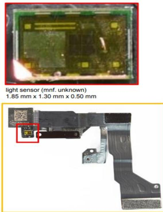
Slika 15. Predodžba senzora za svjetlo
