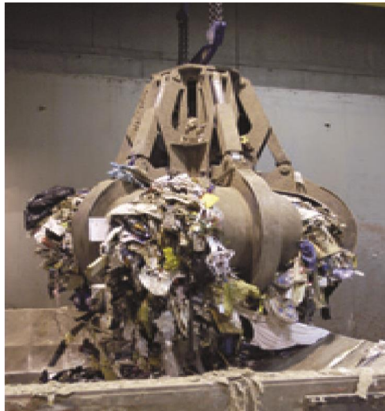
Slika 8. Predodžba kрана za premještanje otpada.[10]
