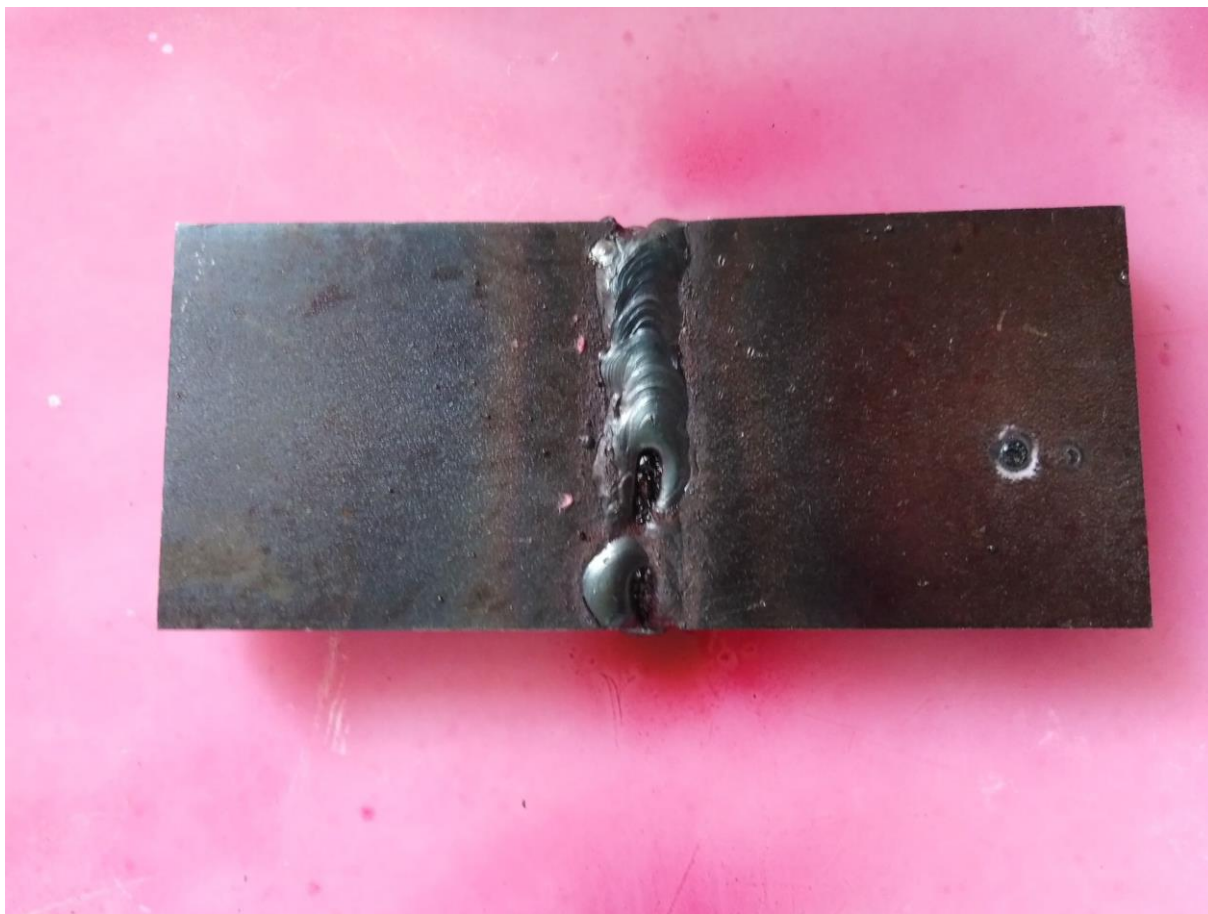
Slika 36 Očišćeni ispitni objekt 2 spreman za nanošenje penetranta
