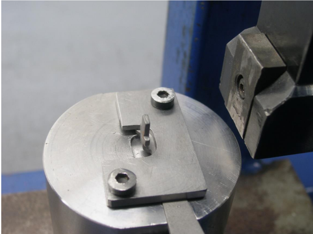
Slika 49: Ispitni uzorak stegnut u pripremi i bat
