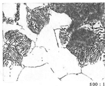
Slika 17: Čelik sa 0,98% C, 900°C/6min, 700°C/voda ; Napredovanje transformacije perlita [4]
