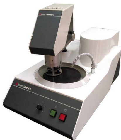
Slika 55: Uređaj za poliranje Struers LoboPol-5
