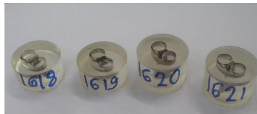
Slika 56: Uzorci pripremljeni za metalografsku analizu
