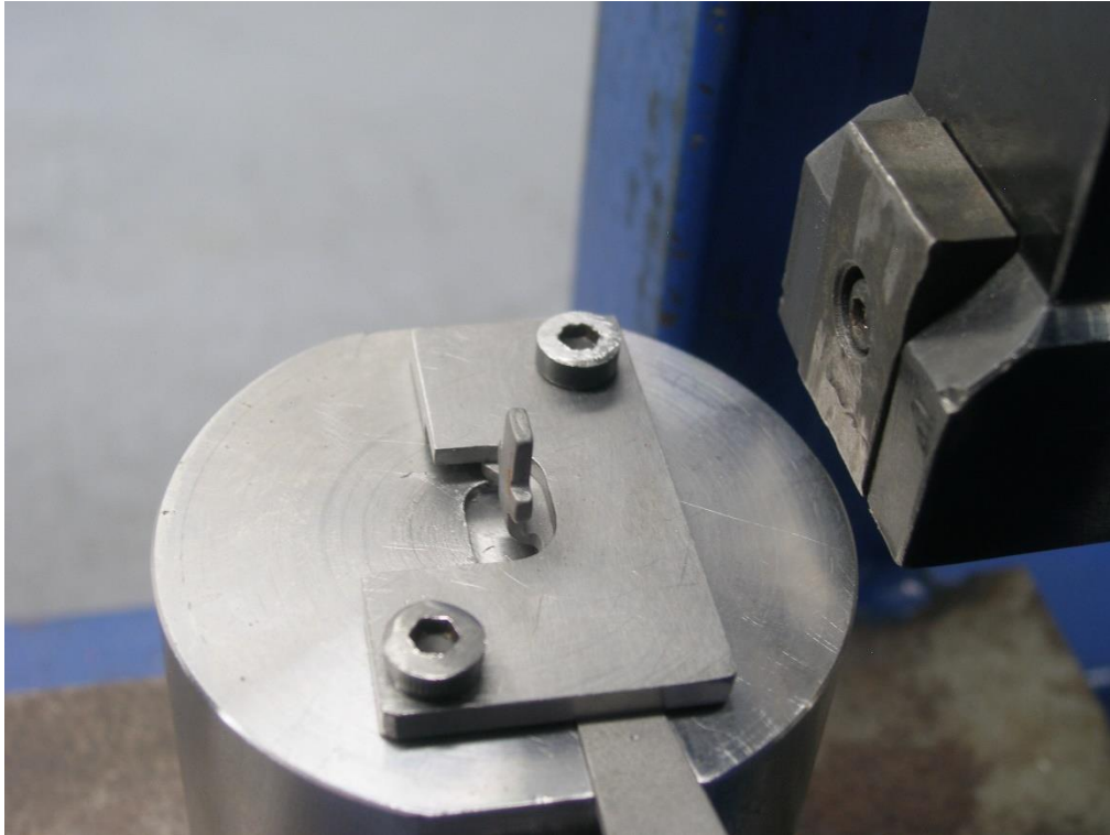
Slika 49: Ispitni uzorak stegnut u pripremi i bat
