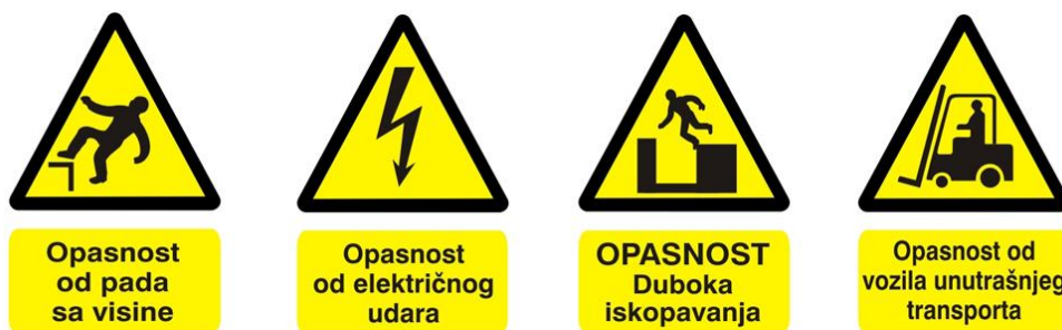
Slika 7. Znakovi opasnosti na gradilištu [16]
