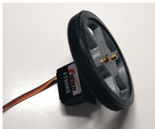
Slika 7 - FT90MR servo motor a), servo motor sa kotačem b)
