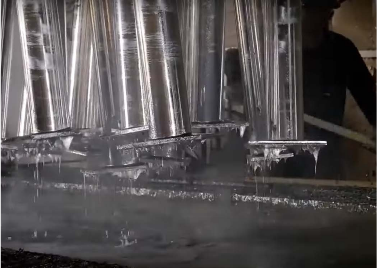
Slika 23. Uranjanje u rastaljeni cink [17]
