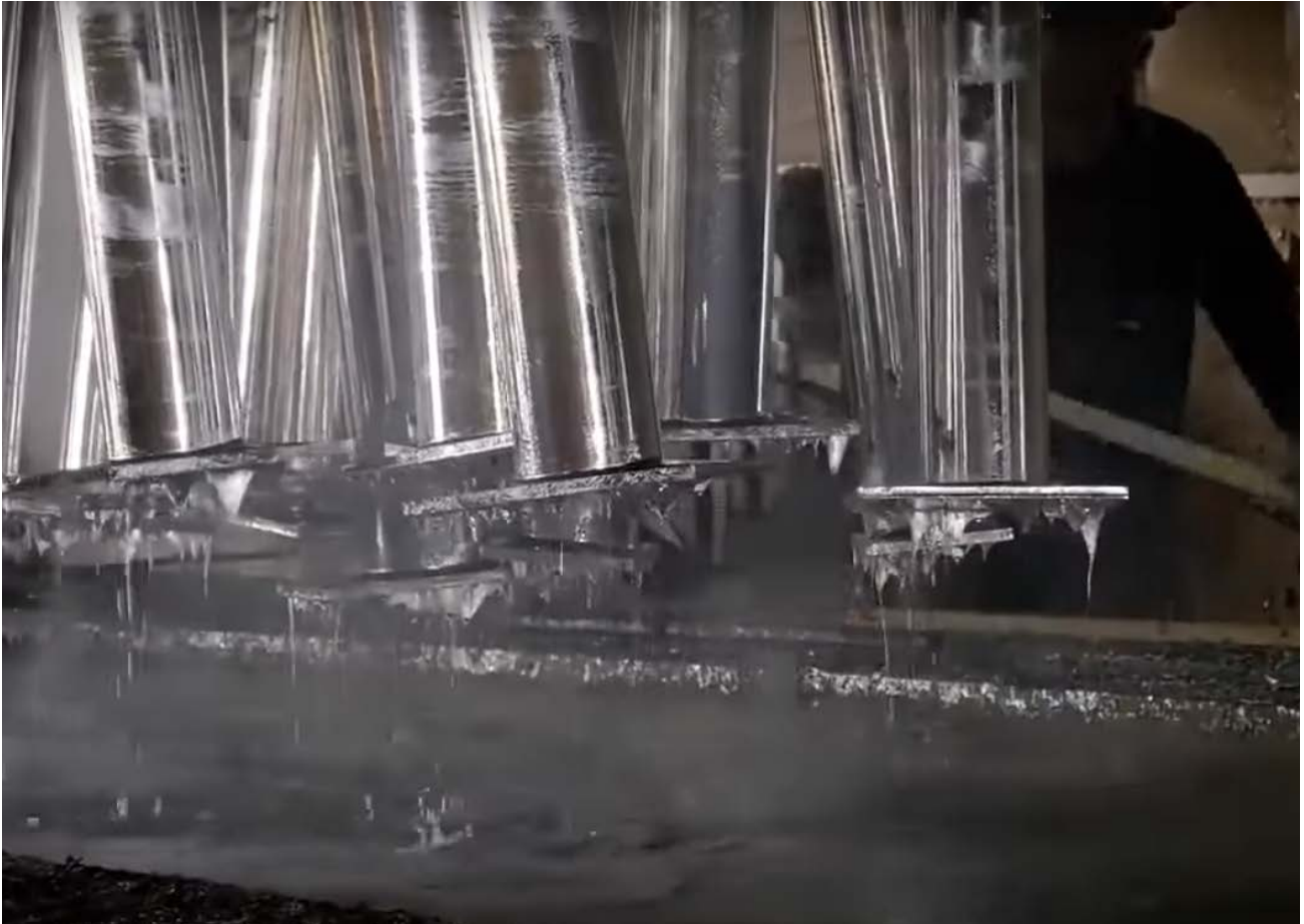
Slika 23. Uranjanje u rastaljeni cink [17]
