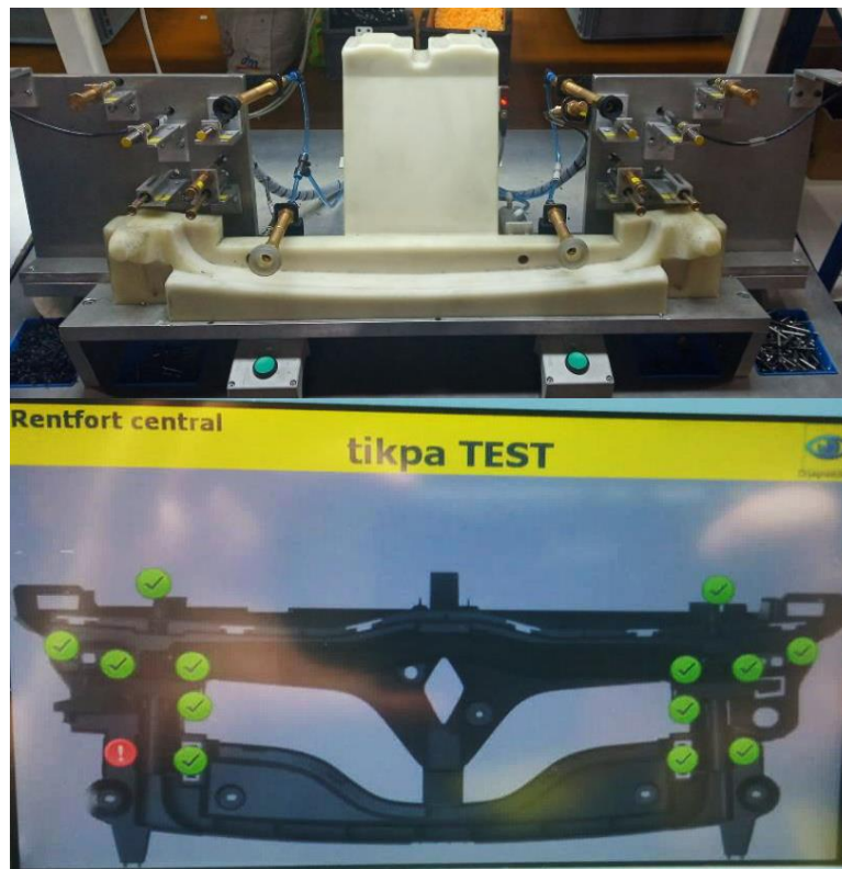
Slika 31. Primjer izgleda Poka-yoke i njenog zaslona
