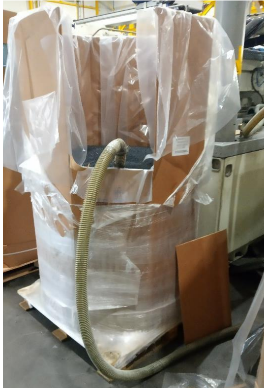
Slika 40. Oktabin sa granulatom materijala
