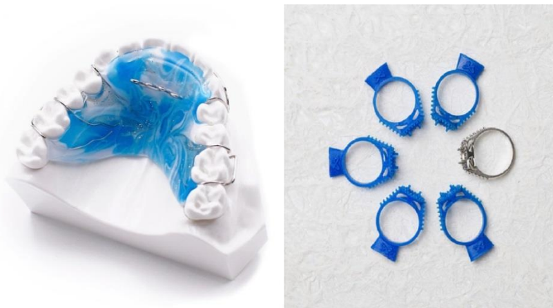
Slika 8. Primjeri proizvoda nastalih SLA postupkom. [11]
