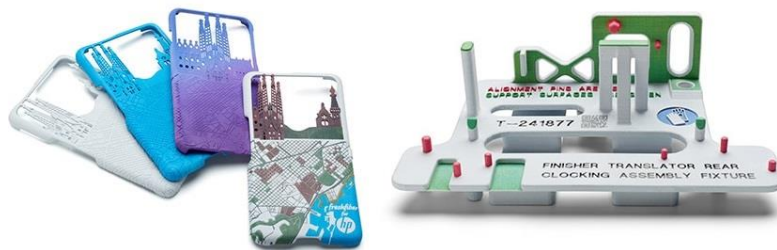
Slika 17. Proizvodi nastali 3DP postupkom. [19]
