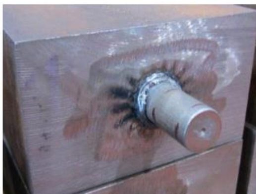
Slika 35 Obradak sa svornjakom zavarenim u vodoravnom položaju [18]
