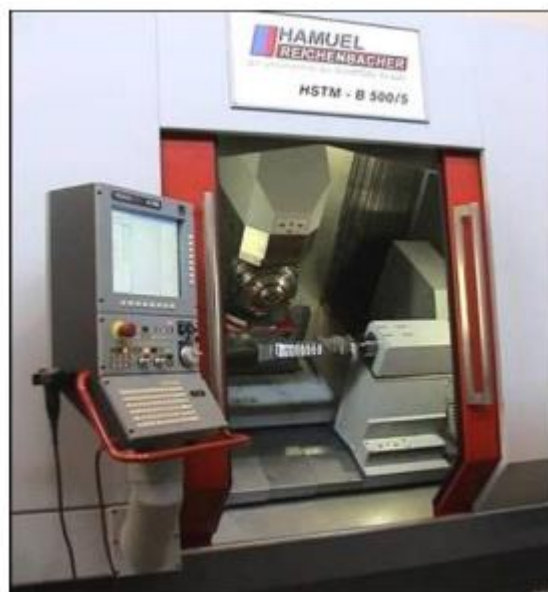
Slika 29 5-osni CNC stroj za obradu tip HAMUEL HSTM B500 [18]
