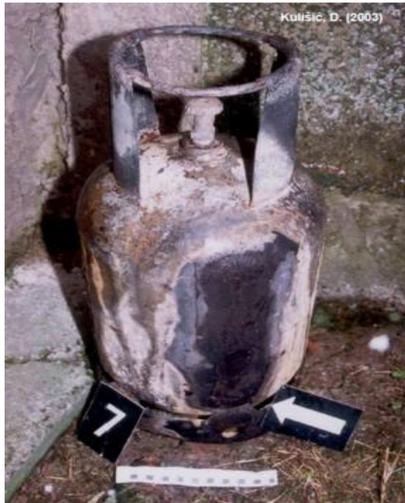
Slika 19. Izgled plinske boce nakon eksplozije plina.[29]
