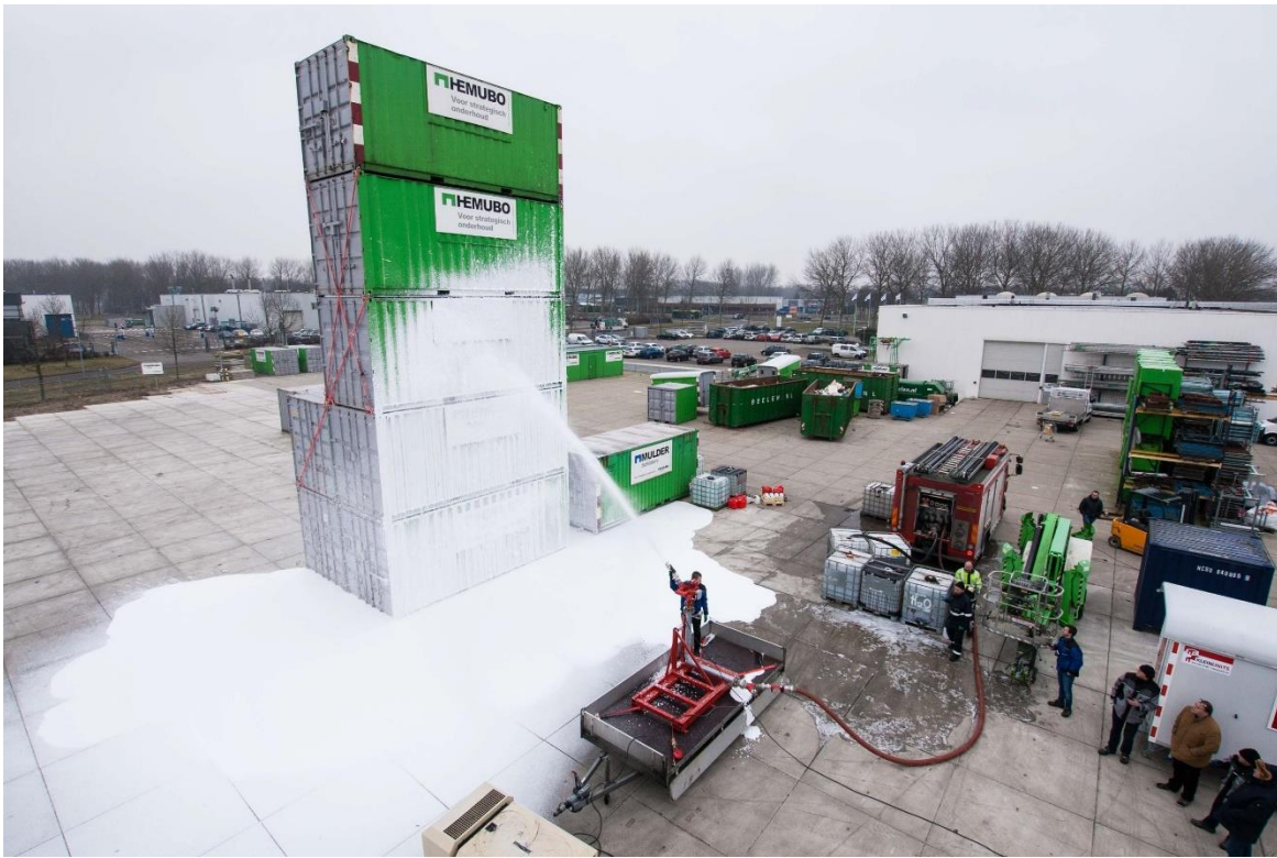
Slika 11. Prijanjanje pjene dobivene CAFS-om na vertikalnu površinu.[16]
