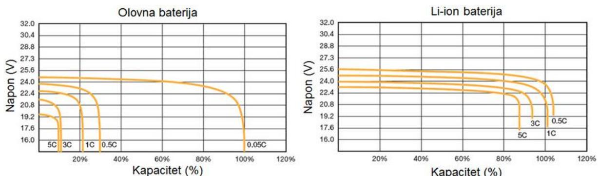
Slika 8. Ovisnost kapaciteta i napona o struji pražnjena olovne i Li – ion baterije.[18]
