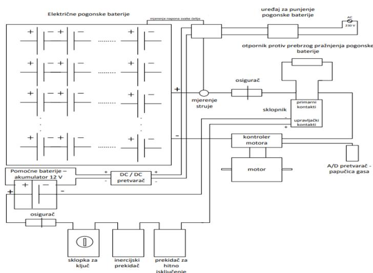
Slika 10. Shema električnog sklopa kod električnih strojeva.[19]
