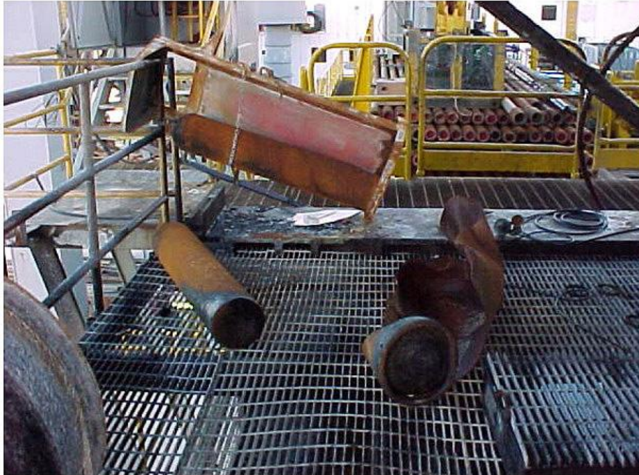
Slika 24. Izgled boce acetilena nakon eksplozije
