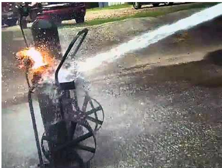
Slika 26. Zapaljenje boce s acetilenom i zalijevanje vodom
