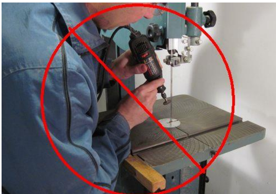
Slika 9. Nepravilno oštrenje zupca tračne pile [9]
