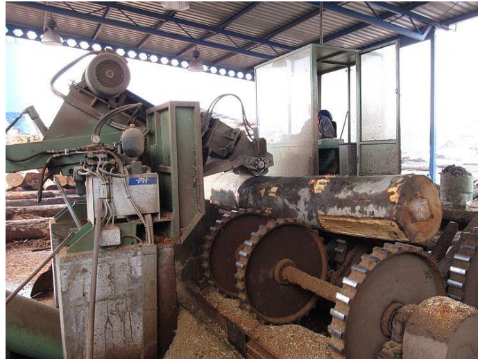
Slika 21. Skidanje kore trupaca „Drvni centar Glina“ [21]
