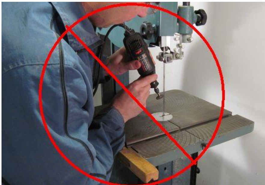
Slika 9. Nepravilno oštrenje zupca tračne pile [9]
