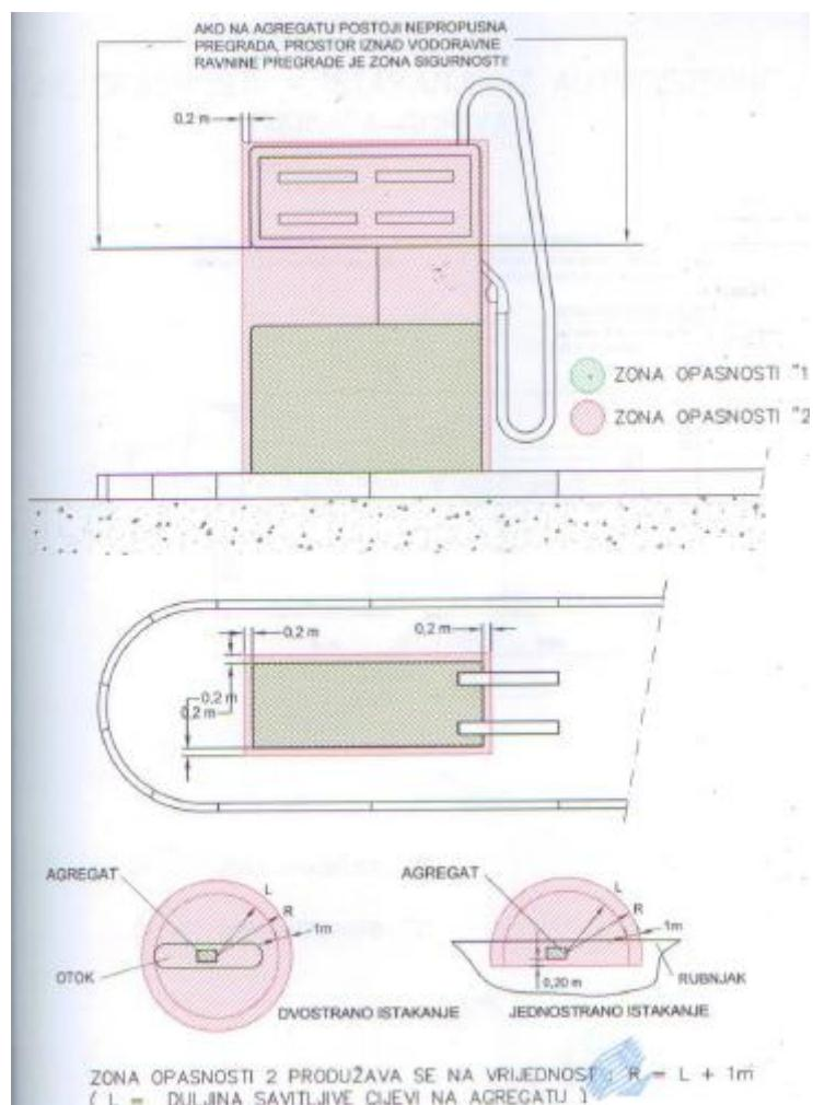
Slika 9. Zone opasnosti- agregat za istakanje tekućih goriva [4]
