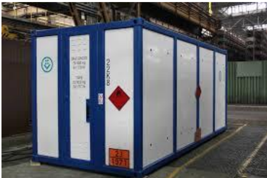
Slika 18. MEGC (Multiple element gas container) kontejner
