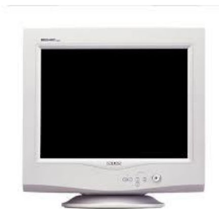
Sl. 3. Prikazna jedinica s CRT zaslonom
