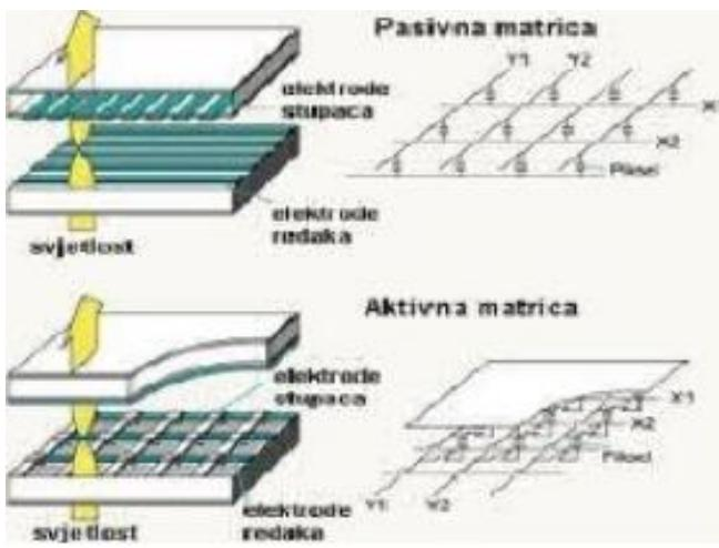
Sl. 5. Pojednostavljeni prikaz LCD zaslona sa aktivnom i pasivnom matricom
