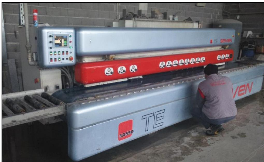
**Slika 12. Stroj za poliranje**
