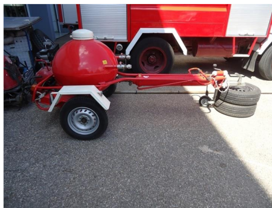
Sl. 30. Prijevozni aparat za gašenje prahom 250kg
