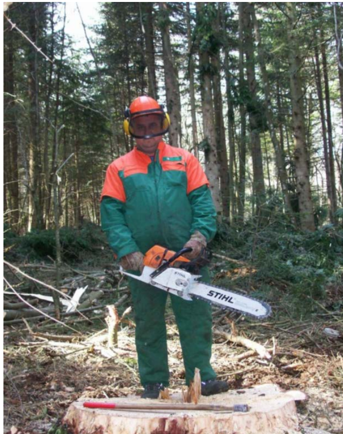
Slika 7. Radnik-sjekač s potpunom zaštitnom opremom
