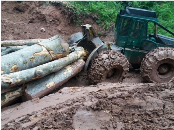
Slika 13. Štete nastale na tlu i na rubnim stablima uz vlak
