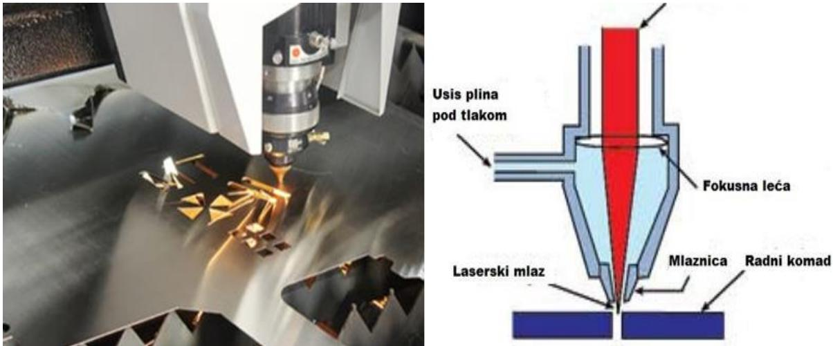
Sl. 22. Primjer i shema rezanja laserom [36]
