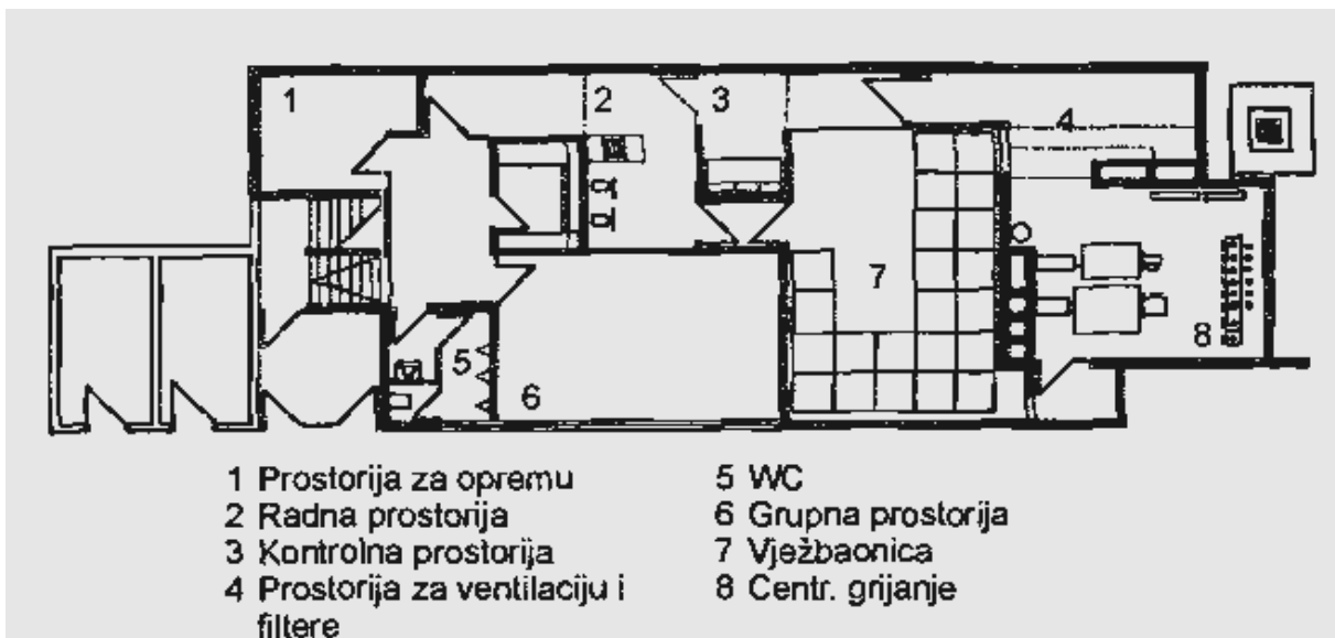
Slika 11. Prikaz vatrogasne zgrade
