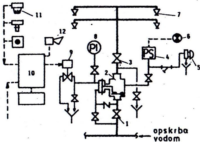
Slika 16 Shema drencher sustava [16]
