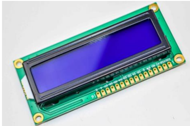
Slika 12. Predodžba LCD-a 16x2.
