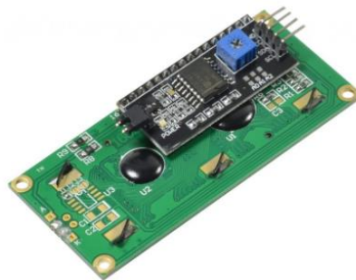
Slika 13. Predodžba adaptera za LCD 16x2.
