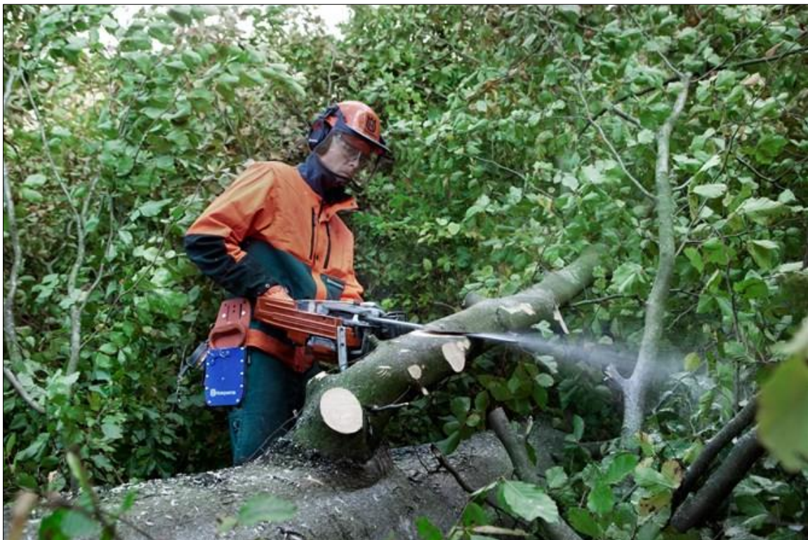
Slika 16. Piljenje grana (izvor: http://www.husqvarna.com/ 2014.)
