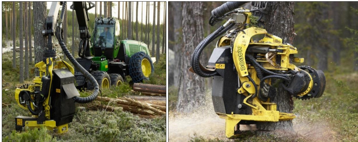
Slika 22: Prikaz rada harvesteri i detalj harvesteri glave
