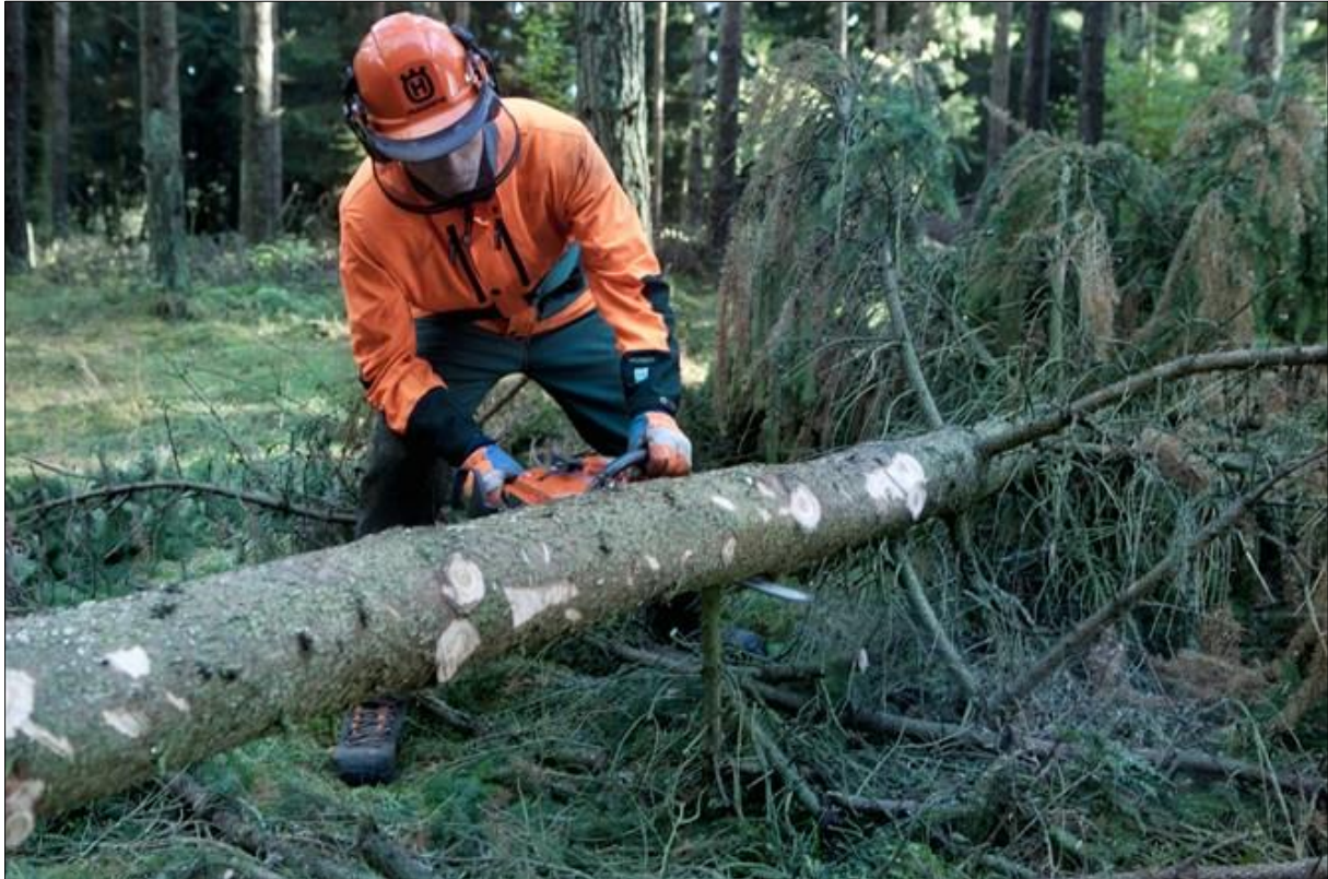
Slika 18. Otkres grana cijelog debla (izvor: http://www.husqvarna.com/ 2014.)
