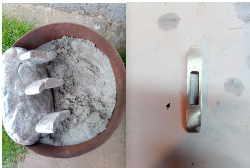
Slika 64 Odljevак i finalni oblik nakon brušenja
