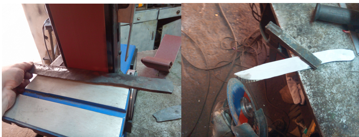
Slika 58 Prikaz brušenja i izrezivanja oblika
