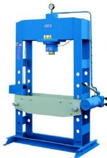
Slika 34 Hidraulična preša [7]
