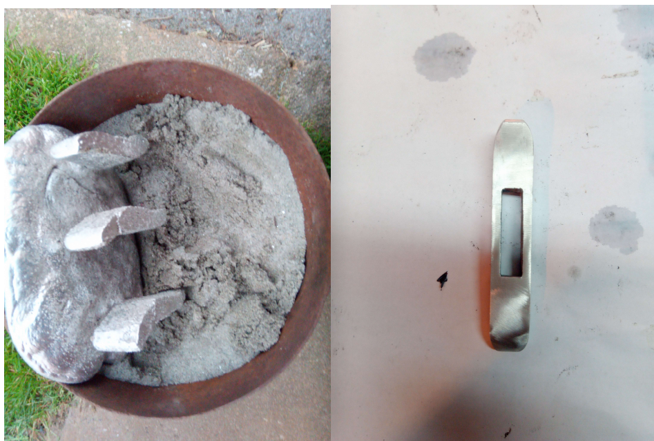
Slika 64 Odljevak i finalni oblik nakon brušenja
