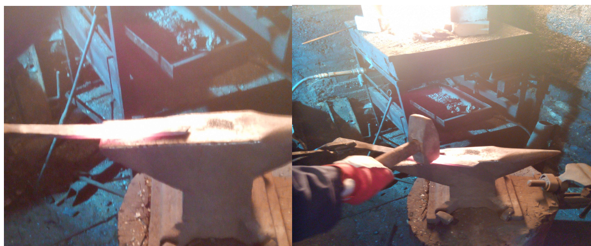
Slika 55 Ugrijavanje šipkastog materijala na kovačkoj vatri
