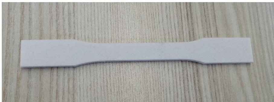
Slika 18. Epruveta za statički vlačni pokus.
