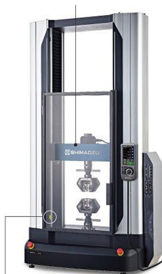
Slika 24. Kidalica Shimatzu AG-X plus.
