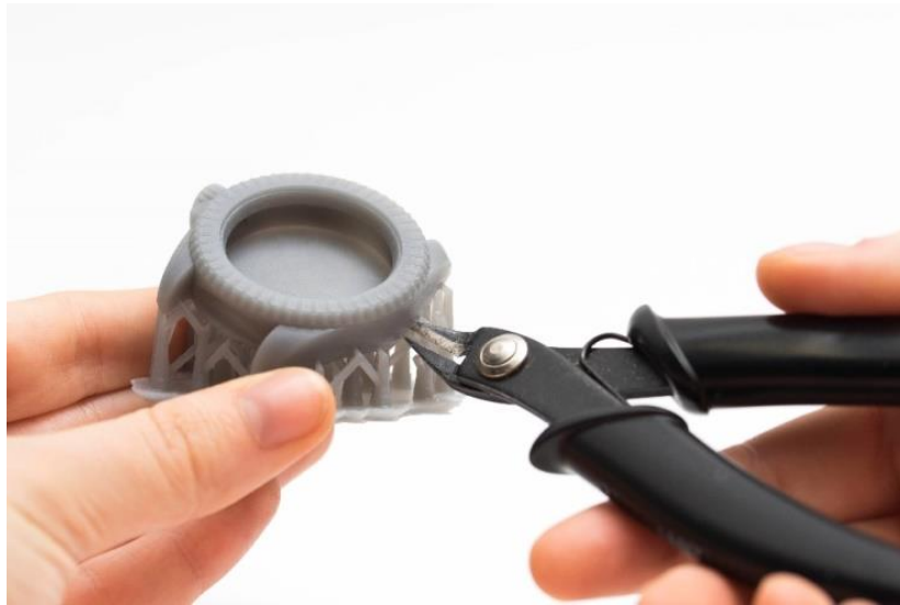
Slika 7. Uklanjanje potporne strukture (SLA). [7]
