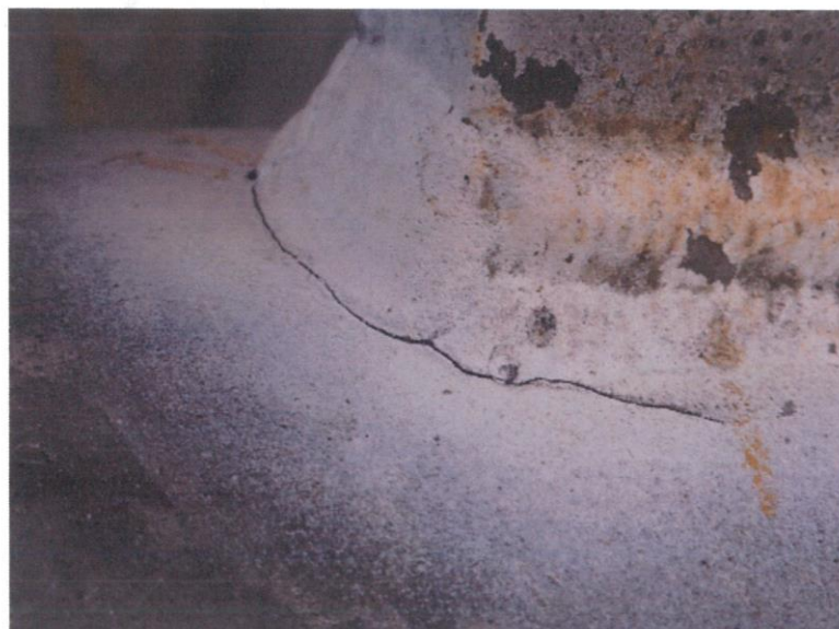
Slika 31: Magnetska indikacija – crno-bijela tehnika [3]
