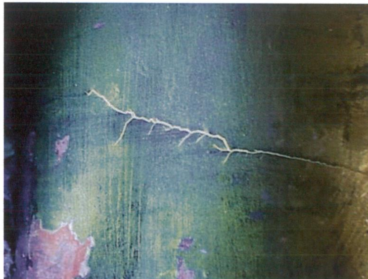
Slika 12: Ispitivanje flurescentnim penetrantom [2]
