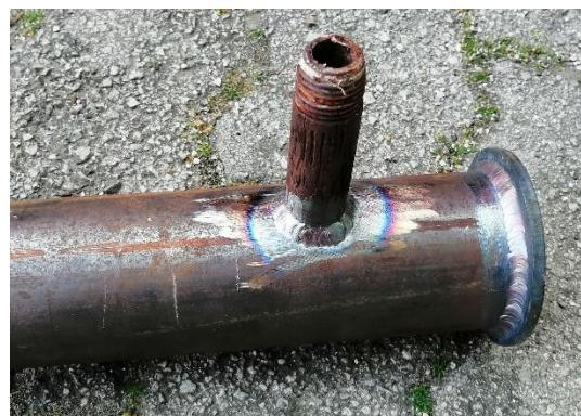
*Slika 43. Zavareni spoj za manometarski ventil*
