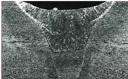
Slika 32. Pogreške naljepljivanja među slojevima [24]
