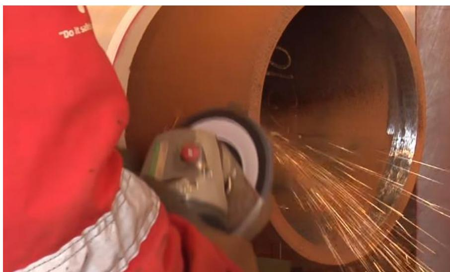
Slika 17. Priprema spoja za zavarivanje – čišćenje od korozije
