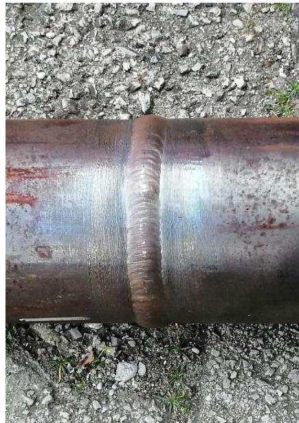
*Slika 45. Ispitani sučevni zavar na cijevnom sklopu*
