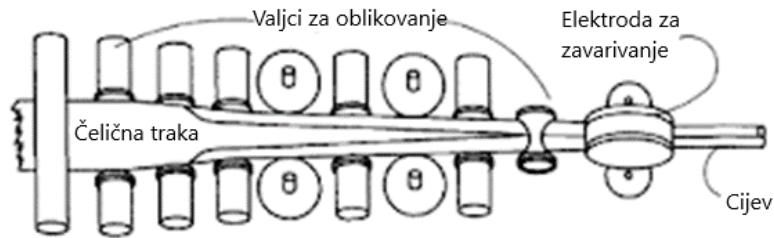
*Slika 5. Način proizvodnje šavnih cijevi [6]*
