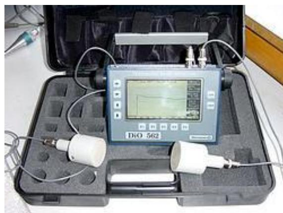
*Slika 37. Uredaj za ultrazvučno ispitivanje [30]*
