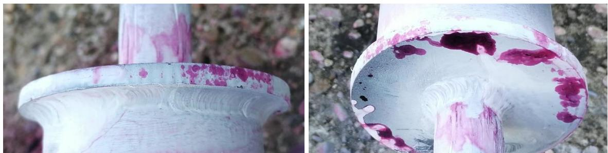
Slika 47. Izgleda zavara nakon nanošenja razvijača
