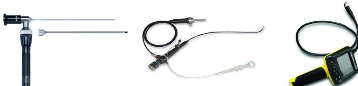
*Slika 34. Boreskop, fibreskop, videoskop [26] [28] [27]*
