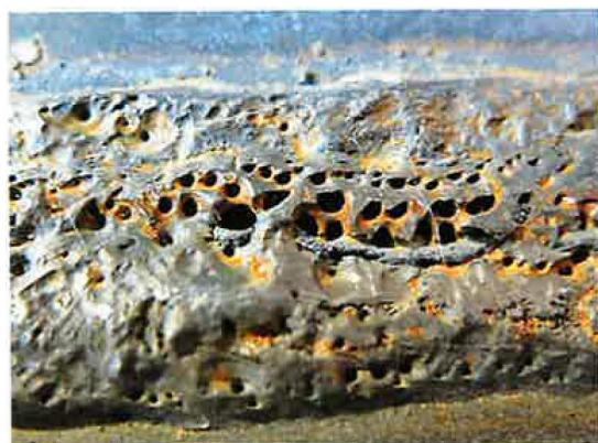
Slika 30. Površinska poroznost pri EPP zavarivanju čelika [24]
