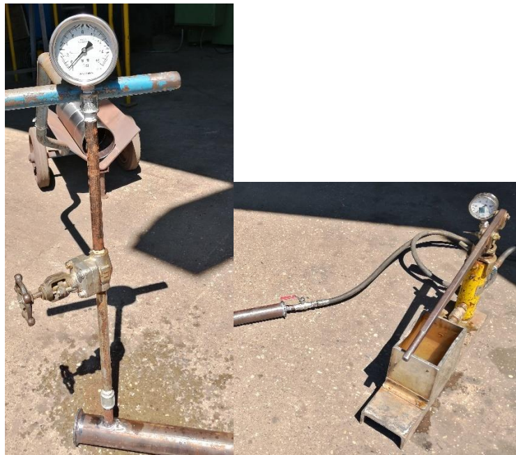
Slika 48. Spojeni manometar i pumpa za vodu na cijevnom sklopu
