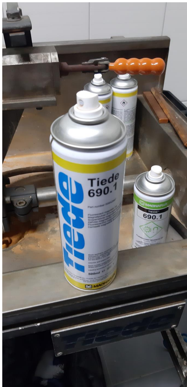
Slika 42. Magnetske čestice u spreju
