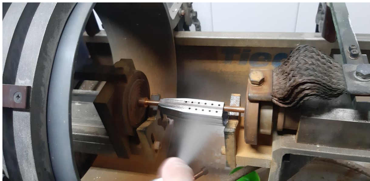
Slika 43. Nanošenje magnetskih čestica
