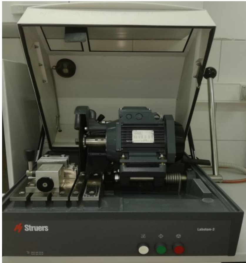
Slika 44. Rezanje epruvete na rezačici Labotom-3
