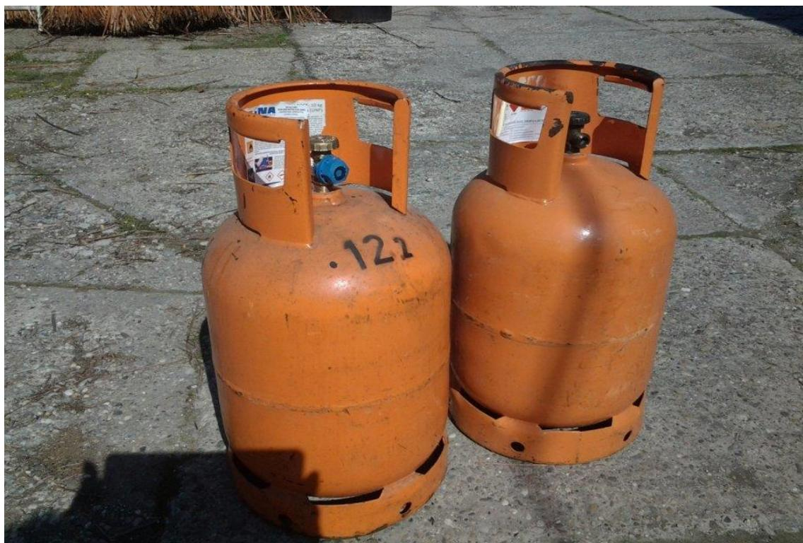
Slika 7. Plinske boce zapremljene 10 kg [6]
