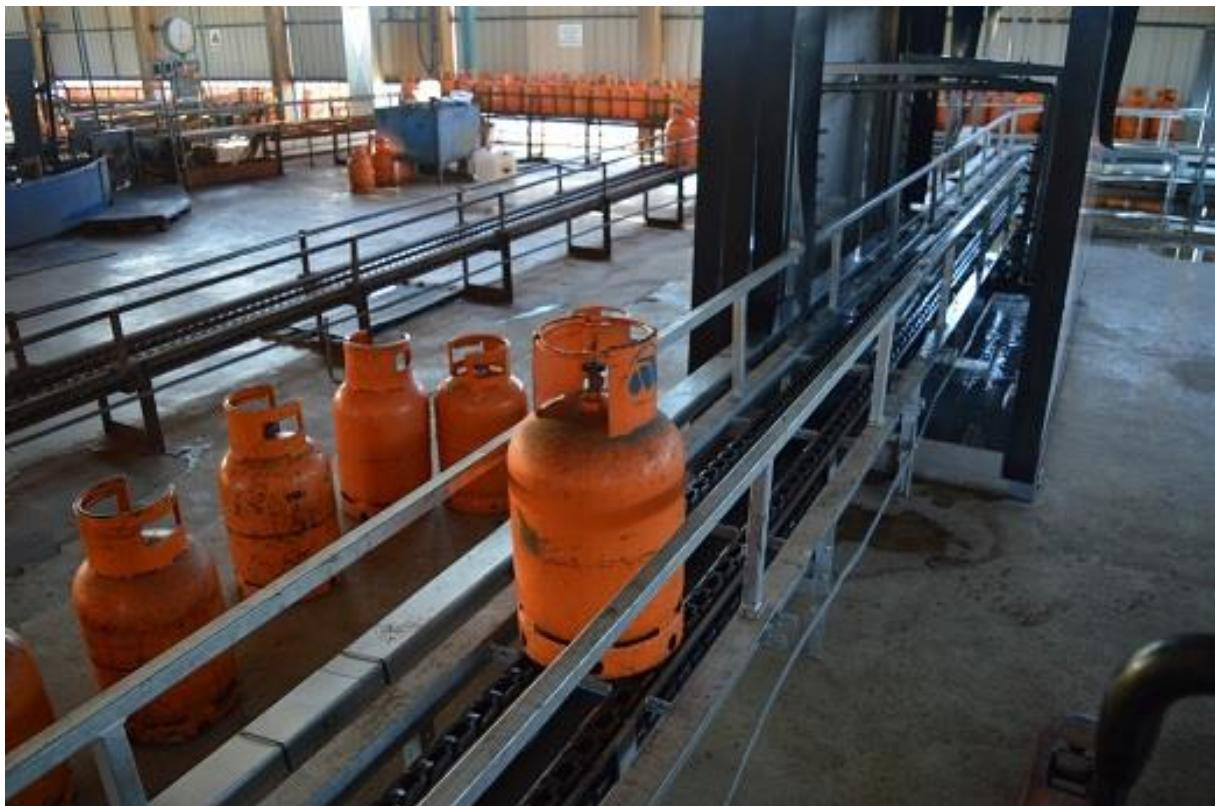
Slika 14. Skladište plinskih boca/manipulacija na pokretnoj traci [2]
