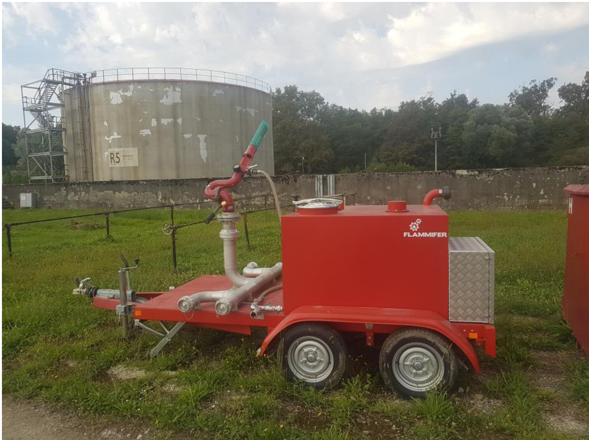
Slika 45. Prijevozni bacač vode/ pjene
