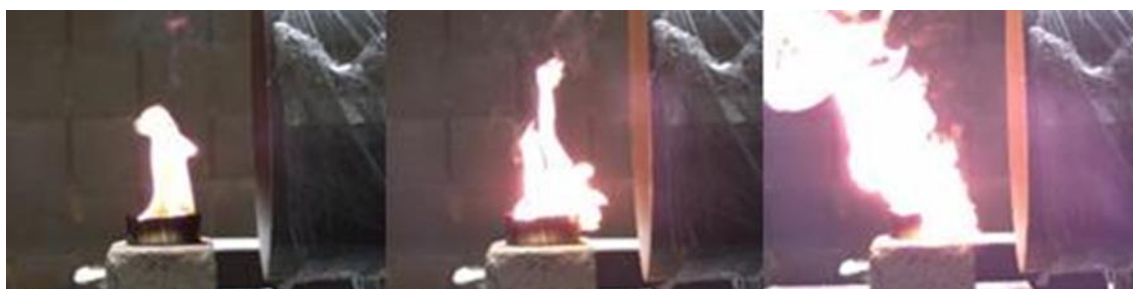
Slika 29. Gašenje zapaljivih tekućina zvukom.[15]
