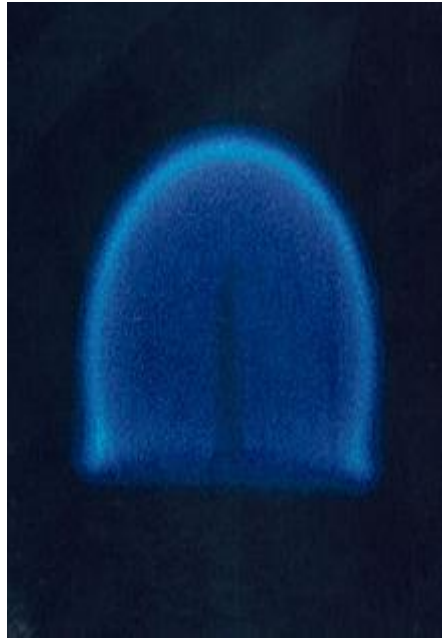
Slika 10. Kuglasti oblik plamena kod nulte gravitacije.[5]
