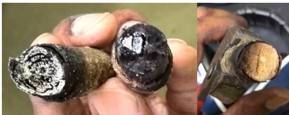
Slika 27. Penetracija vatre u drvetu.[15]
