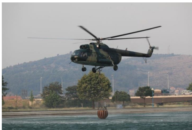
Slika 24. Helikopter Mi 8 MTV-1 opremljen elastičnim vjedrom [20]
